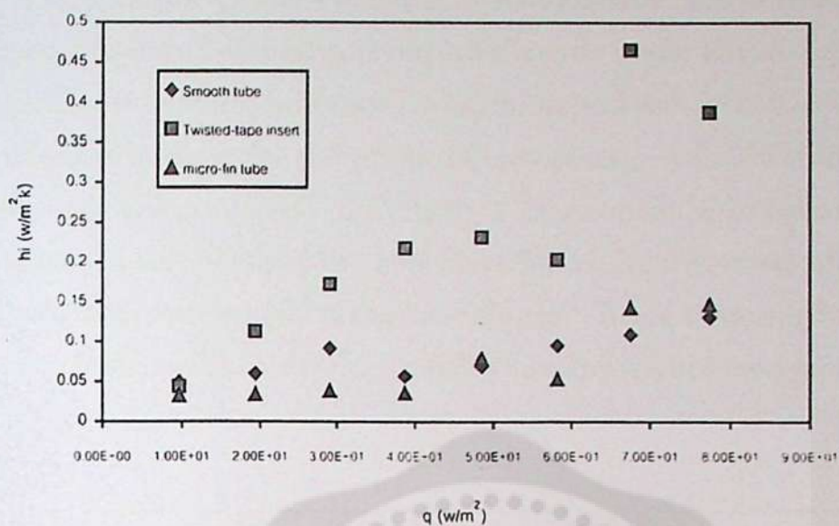
รูปที่ 4.9 แสดงความสัมพันธ์ระหว่างอัตราการถ่ายเทความร้อนต่อพื้นที่ผิวท่อ( q )กับสัมประสิทธิ์การถ่ายเทความร้อนในท่อ ( h_i ) ทั้ง 3 ชนิดที่อุณหภูมิน้ำเข้า 18^\circ\text{C}
