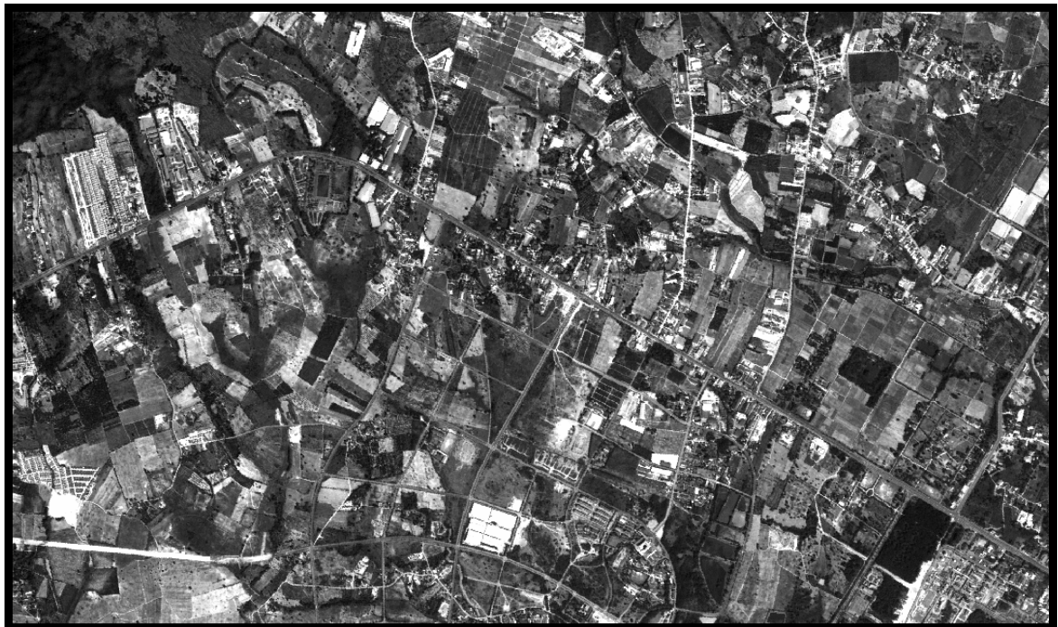
ภาพประกอบ 8 ข้อมูลภาพถ่ายดาวเทียม SPOT 5 Level 2A ช่วงคลื่นแพนโครมาติก ครอบคลุมพื้นที่บริเวณจังหวัดระยอง ซึ่งนำมาใช้เป็นภาพต้นฉบับ
