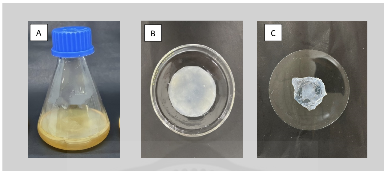
ภาพที่ 4.4 การผลิตแบคทีเรียเซลลูโลสของสัดส่วน 25% A) แสดงรูปแบบที่เรียลเซลลูโลส ในอาหารเลี้ยงเชื้อ Hestrin & Schramn (HS) ที่การเลี้ยงแบบนิ่งระยะ 7 วัน B) แผ่นแบคทีเรียเซลลูโลสที่ผ่านกระบวนการล้างจนมีค่า pH 7.7 C) และแผ่นแบคทีเรียเซลลูโลสแห่งที่ผ่านการอบที่ 105°C เป็นเวลา 12 ชั่วโมง
