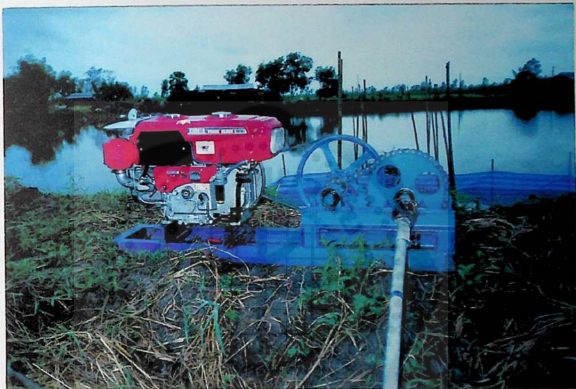
รูปภาคผนวกที่ 4.11 แสดงภาพการนำเครื่องจักรกลมาเป็นต้นกำลังของระหัดวิดน้ำ
