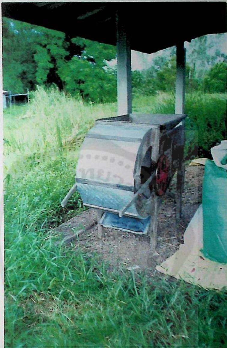
รูปภาคผนวกที่ 4.12 แสดงภาพเครื่องนวดข้าวที่ใช้สายพานต่อกับเครื่องจักรกล
