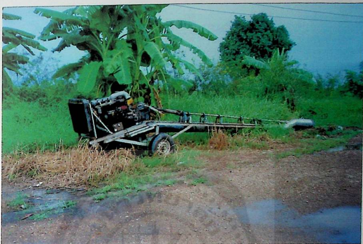
รูปภาคผนวกที่ 4.7 แสดงภาพเครื่องสูบน้ำที่ใช้เครื่องยนต์เป็นต้นกำลัง
