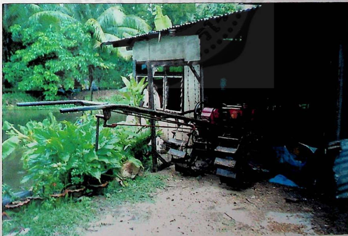
รูปภาคผนวกที่ 4.6 แสดงภาพรถไถเดินตาม 2 ล้อ (ขนาด 110 แรงม้า)
