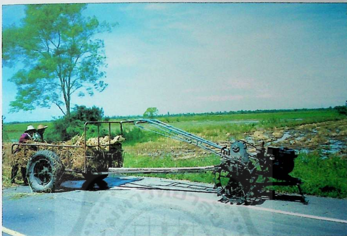
รูปภาคผนวกที่ 4.5 แสดงภาพการนำรถไถเดินตาม 2 ล้อมาประยุกต์ใช้ในการขนส่ง
