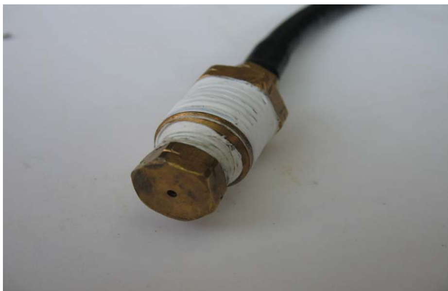
ภาพประกอบ 36 หัวฉีดที่ใช้ในการทดลอง
