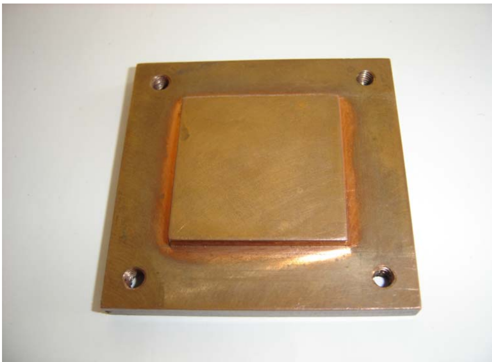
ภาพประกอบ 32 ส่วนสำหรับติดตั้งครีบบระบายความร้อนที่ทำจากทองแดง
