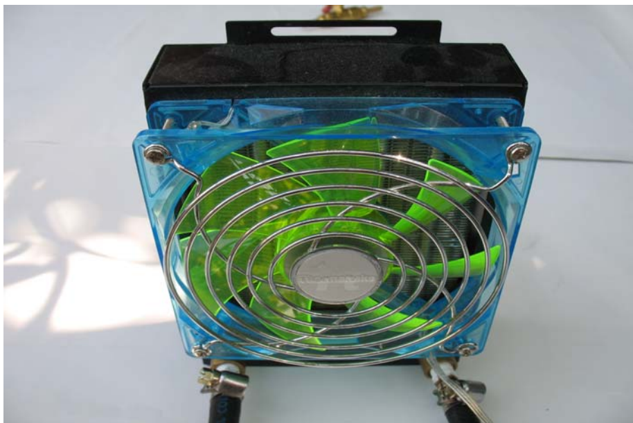
ภาพประกอบ 40 หม้อน้ำพร้อมติดตั้งพัดลม
