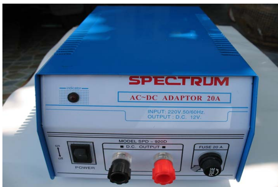
ภาพประกอบ 39 แหล่งจ่ายไฟ
