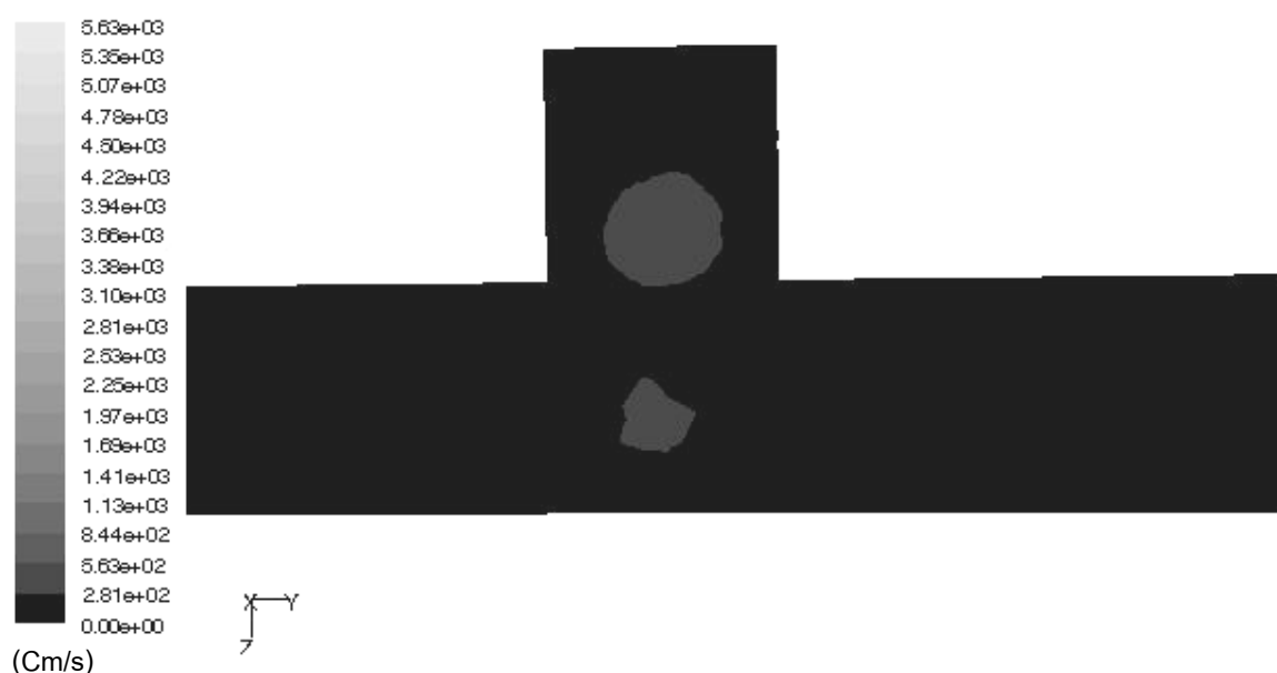
ภาพประกอบ 51 แสดงคอนทัวร์ความเร็วที่ทางออก X=22.63 มิลลิเมตร
