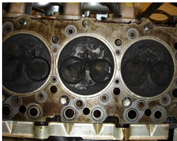
ภาพประกอบ 57 แสดงปริมาณเขม่าที่จับที่ปลายลูกสูบหลังการทดสอบ
