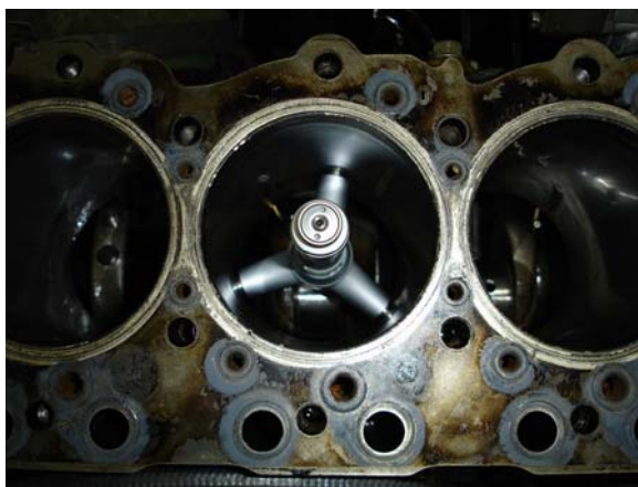
ภาพประกอบ 54 แสดงการวัดเส้นผ่าศูนย์กลางของกระบอกสูบจุดที่ 2
