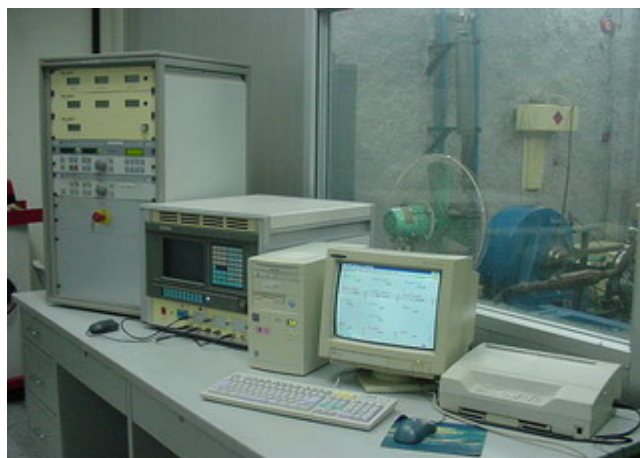
ภาพประกอบ 8 แสดงชุดควบคุมไดนาโมมิเตอร์
