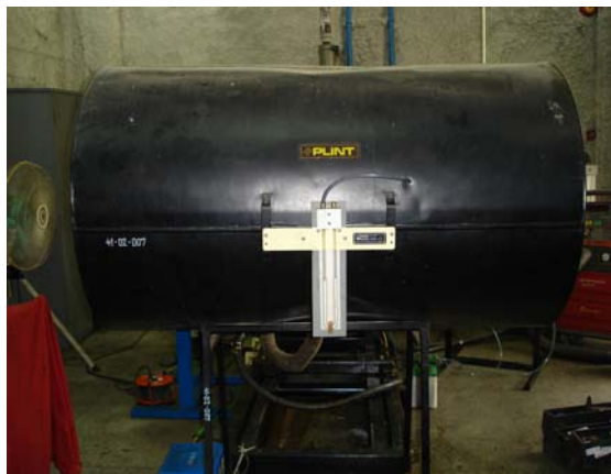
ภาพประกอบ 12 แสดงอุปกรณ์วัดปริมาณอากาศ
