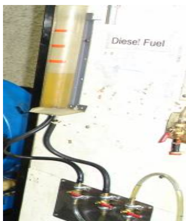
ภาพประกอบ 13 แสดงอุปกรณ์วัดอัตราการสิ้นเปลืองเชื้อเพลิง
