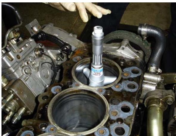
ภาพประกอบ 53 แสดงการวัดเส้นผ่าศูนย์กลางของกระบอกสูบจุดที่ 1
