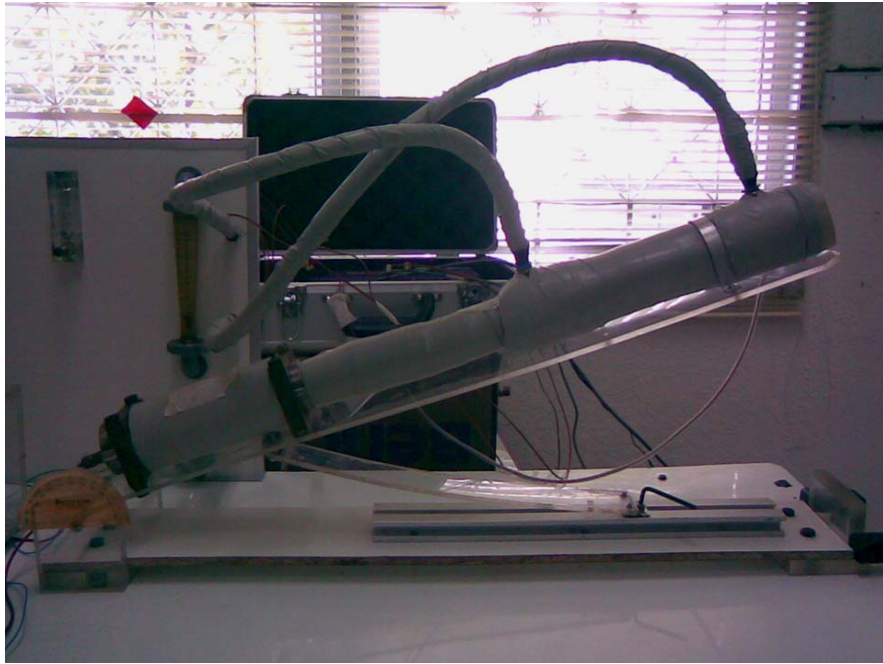
ภาพประกอบ 10 แสดงชุดท่อความร้อนเมื่อทำการติดตั้งและหุ้มฉนวน
