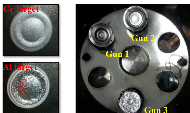
ภาพประกอบ 47 การติดตั้งเป้าสารเคลือบอะลูมิเนียม และ โครเมียม
