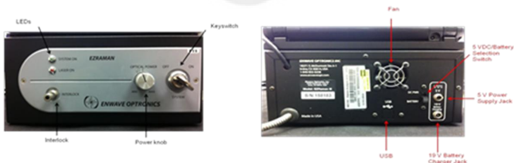
ภาพประกอบ 31 ส่วนประกอบ Power Supply ของเครื่อง EZ Raman
