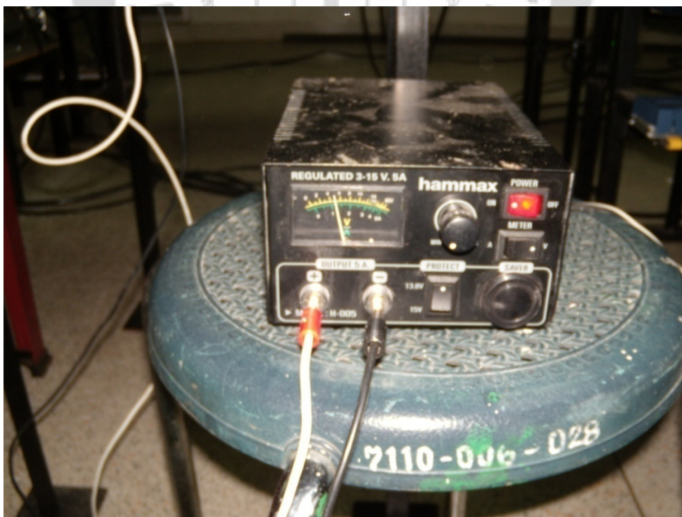
ภาพประกอบ 30 เครื่องปรับแรงดันไฟฟ้าสำหรับเครื่องปั๊มข้าวแบบสายพาน
