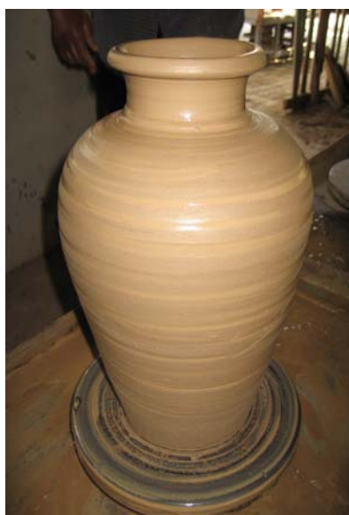
ภาพประกอบ 46 ตั้งทิ้งไว้ 1 คืนเพื่อให้ดินแห้งหมาดๆ จึงตกแต่งอีกครั้ง พร้อมกับติดหูของไหทั้ง 4 ด้าน
