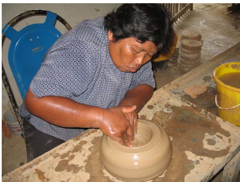
ภาพประกอบ 38 ใช้มือเจาะดินตรงศูนย์กลางเพื่อดึงดินเป็นทรงกระบอก
