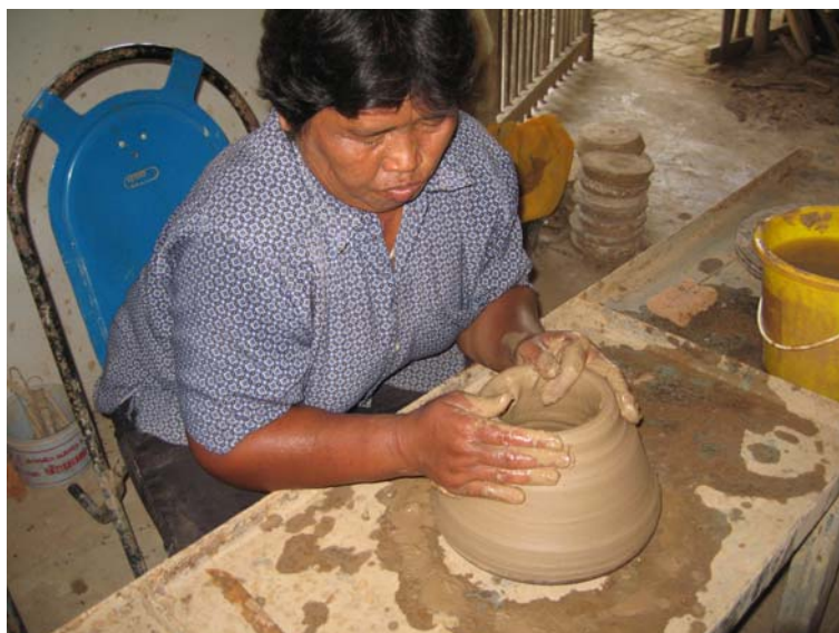
ภาพประกอบ 39 ใช้มือพุงให้ดินสูงขึ้นเป็นทรงกระบอก
