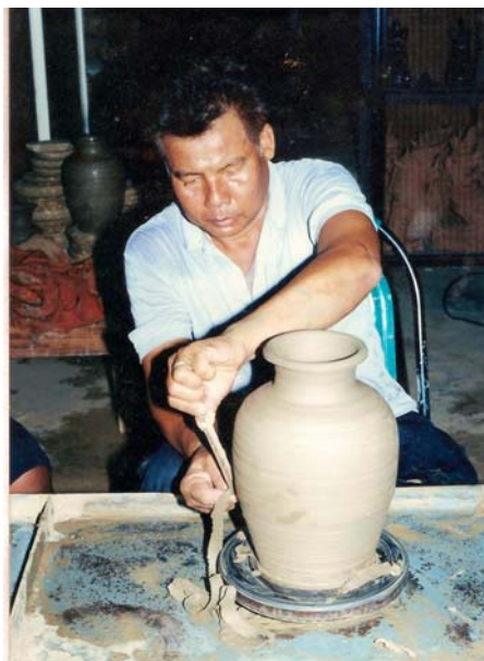
ภาพประกอบ 47 การตกแต่งใช้เหล็กชุดผิวนำให้เรียบและได้รูปทรง
