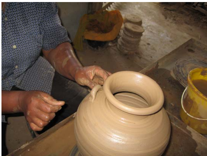
ภาพประกอบ 49 นำดินที่คลึงไว้ ตัดให้ยาวพอประมาณนำมาติดบนตัวไหให้เป็นหูทั้ง 4 ด้าน
