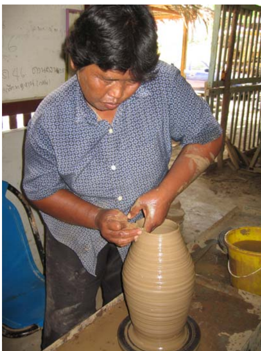
ภาพประกอบ 42 ใช้มือดันจากด้านในเพื่อเปลี่ยนรูปทรงให้เป็นไห
