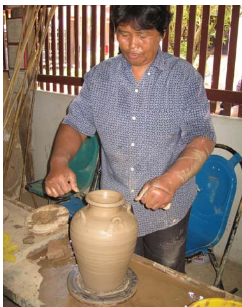
ภาพประกอบ 44 ใช้เอ็นหรือลวดตัดปากที่ม้วนออกให้เรียบ
