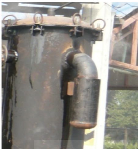
รูปที่ 4.7 ถังนิรภัยป้องกันการระเบิดและจามของเตา
