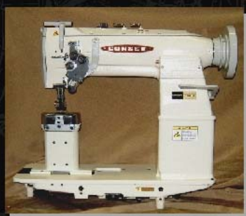
ภาพที่ 1.6. แสดงรูปลักษณะเครื่องจักรฐานทรงแท่นหรือคั้ง
