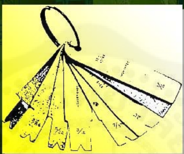
ภาพที่ 2.20. แสดงรูปลักษณะฟीलเลอร์เกจ
