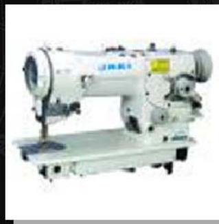
ภาพที่ 1.3. แสดงรูปลักษณะเครื่องจักรฐานแบนชนิด 1 เข็มซิกแซก
