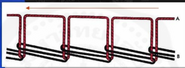
ภาพที่ 1.12. แสดงรูปลักษณะโครงสร้างผีเสื้อลูกโซ่ F.S.T.401
