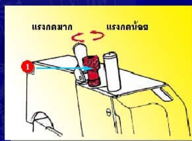
ภาพที่ 7.10 แสดงตำแหน่งและวิธีการปรับแรงกดเท้าทับผ้า
