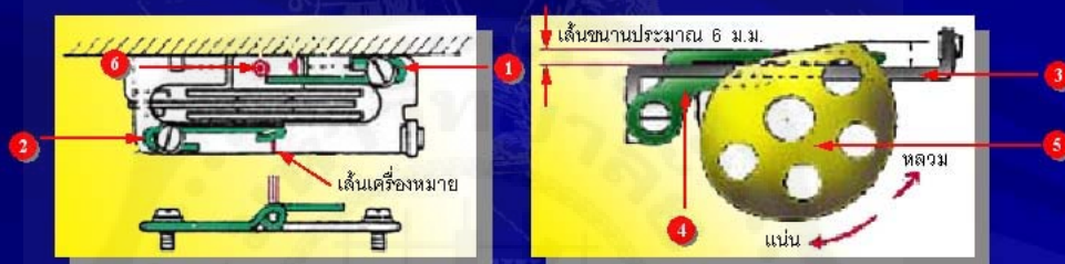
ภาพที่ 7.9. แสดงตำแหน่งและวิธีการปรับก้านกระตุกเส้นด้ายของฝีเข็มลูกโซ่
