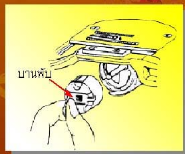
ภาพที่ 3.7. แสดงตำแหน่งและวิธีการถอดใส่กระสวย
