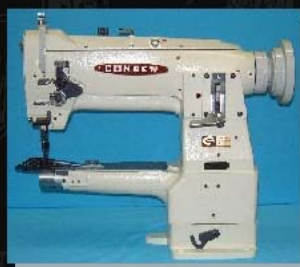
ภาพที่ 1.5 แสดงรูปลักษณะเครื่องจักรฐานทรงกระบอก
