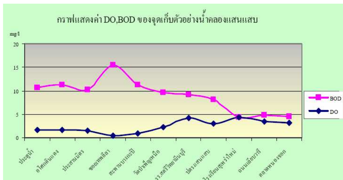
ภาพประกอบ 1 กราฟแสดงค่า DOและ BOD ของจุดเก็บตัวอย่างน้ำคลองแสนแสบ
