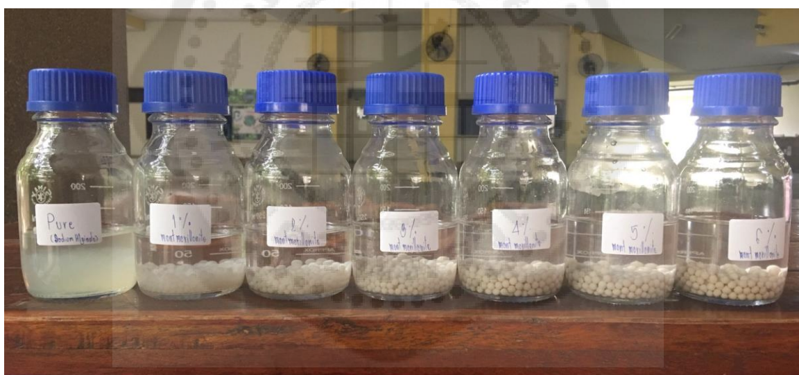
ภาพประกอบ ฅ เม็ดวัสดุแอลจิเนตและเม็ดวัสดุมอนต์มอริลโลไนต์/แอลจิเนต 1%, 2%, 3%, 4%, 5%, และ 6% (w/v)
