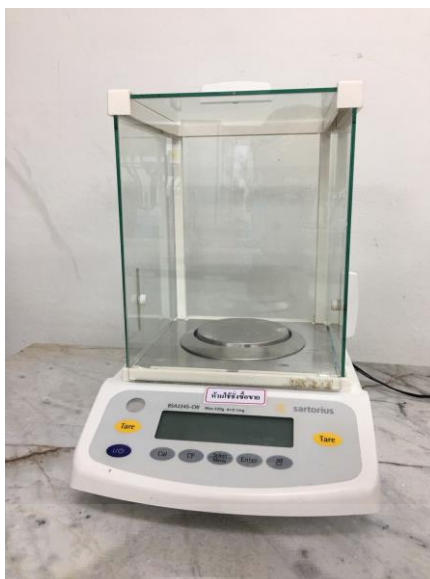
ภาพประกอบ ฐ เครื่องชั่งดิจิตอล ยี่ห้อ Sartorius Model BSA224S – CW 220g/0.1 mg
