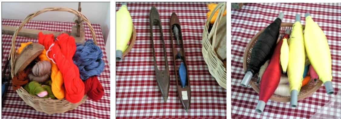
ภาพประกอบ 22 ไยประดิษฐ์ กระสวย และหลอดด้ายพุ่ง บรรจุด้ายสอดอยู่ในรางกระสวย เพื่อใช้พุ่งไปขัดด้ายยืนในการทอผ้า (ถ่ายเมื่อ 2554)
