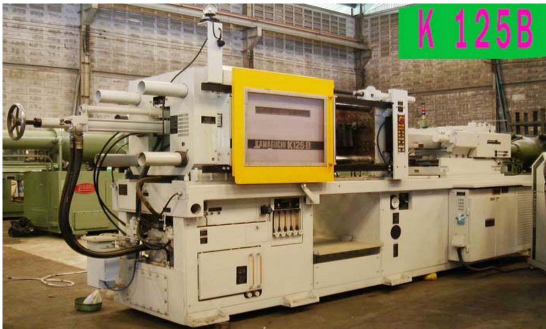
ภาพประกอบ 1 เครื่องฉีดพลาสติกที่มีชุดฉีดวางตัวในแนวนอน (Horizontal Injection Molding Machine)
