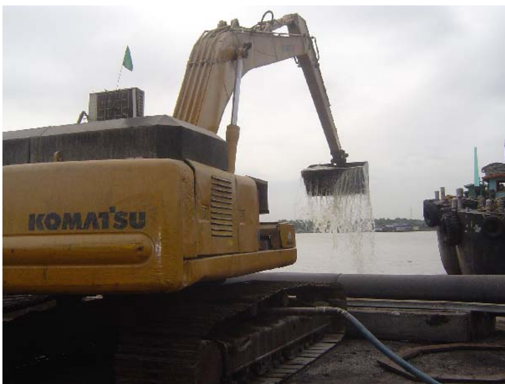
ภาพประกอบ 45 แสดงการทดสอบการตักน้ำ 2 ลบ.ม
