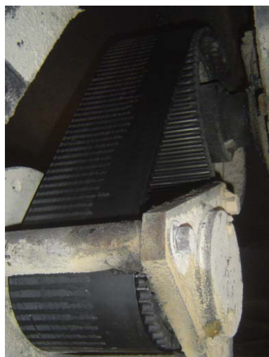
ภาพประกอบ 29 ทิศทางการหมุนและการขับเคลื่อนของสายพาน
