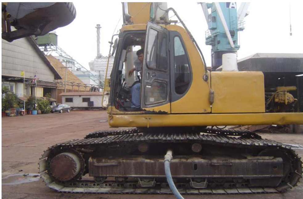
ภาพประกอบ 42 แสดงการทดสอบการเดินทางตรงของรถขุดไฟฟ้า
