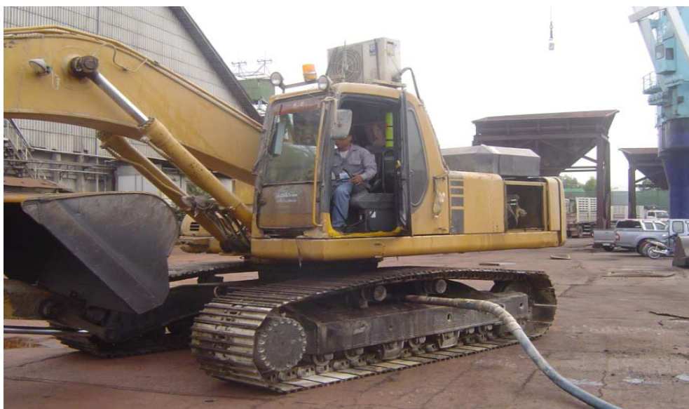
ภาพประกอบ 43 แสดงการทดสอบการเลี้ยวของรถขุดไฟฟ้า
