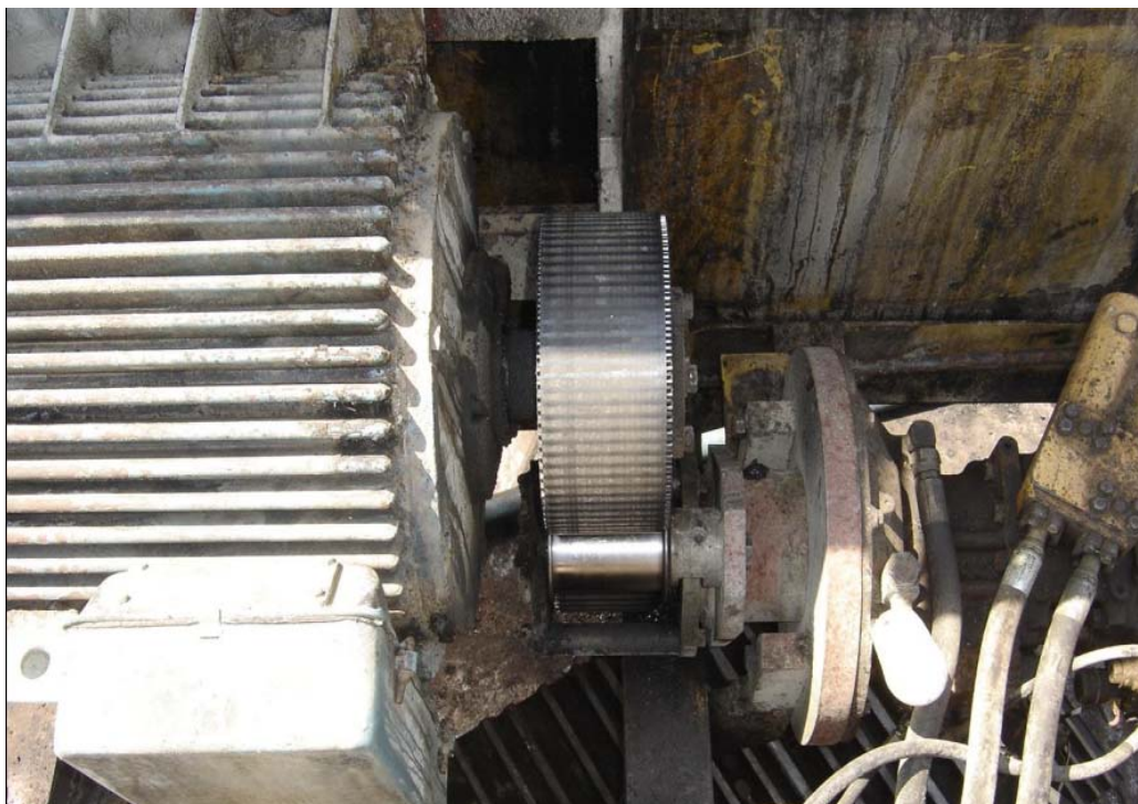
ภาพประกอบ 34 แสดงการติดตั้งระบบส่งกำลังด้วยสายพาน
