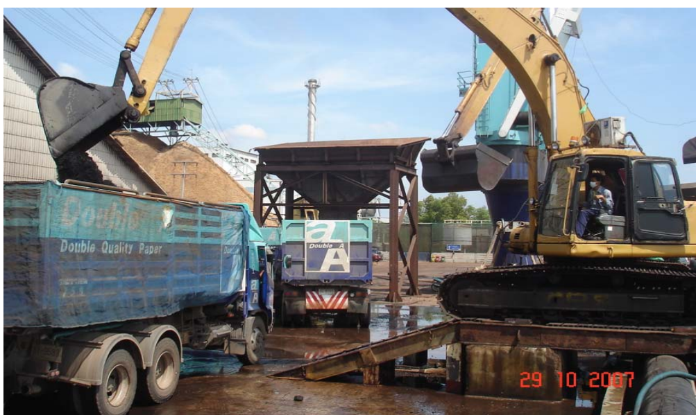
ภาพประกอบ 53 แสดงการทดสอบการตัดถ่านหิน 2 ลบ.ม ขึ้นรถบรรทุก 10 ล้อ
