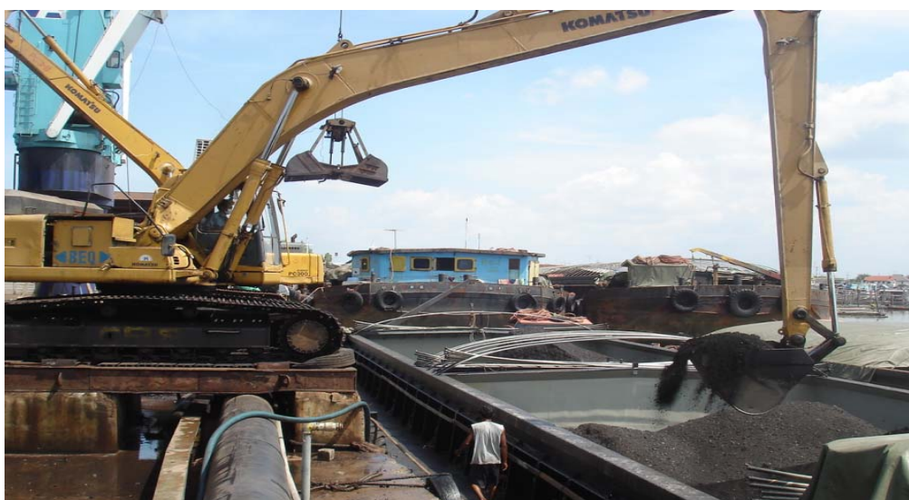
ภาพประกอบ 52 แสดงการทดสอบการตัดถ่านหิน 2 ลบ.ม จากเรือขนถ่าย
