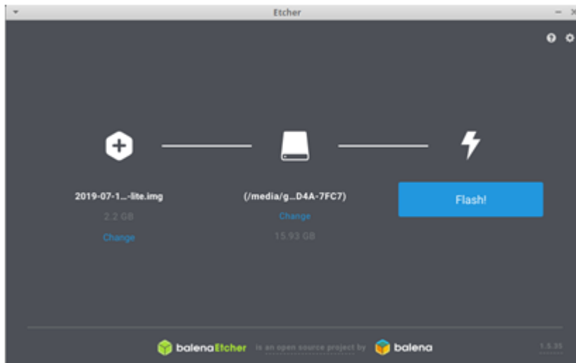
ภาพที่ ก - 3 : ขั้นตอนการติดตั้ง Raspbian โดยใช้ balena etcher
