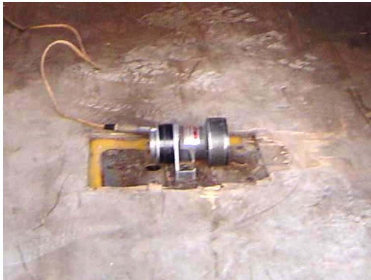
ภาพประกอบ 7 Integrator Unit พร้อมสายสัญญาณต่อไปยัง Romdas Hardware Interface ประมวลผลเป็น BI. Count. Unit
