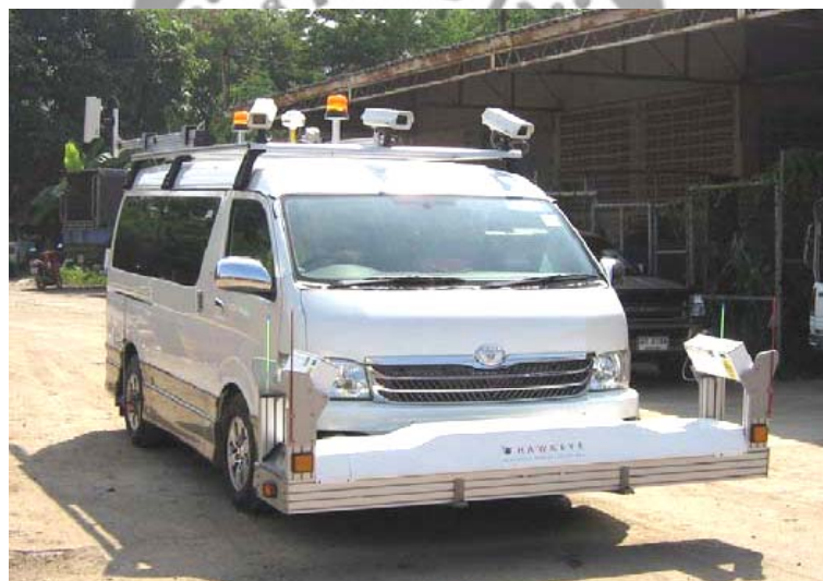
ภาพประกอบ 3 ชุดรถสำรวจ ติดตั้งเครื่องมือวัดและอุปกรณ์ที่มีเทคโนโลยีสูง
