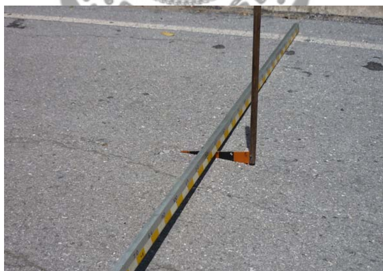
ภาพประกอบ 35 การใช้เครื่องมือวัดระยะการทรุดตัวของผิวทาง
