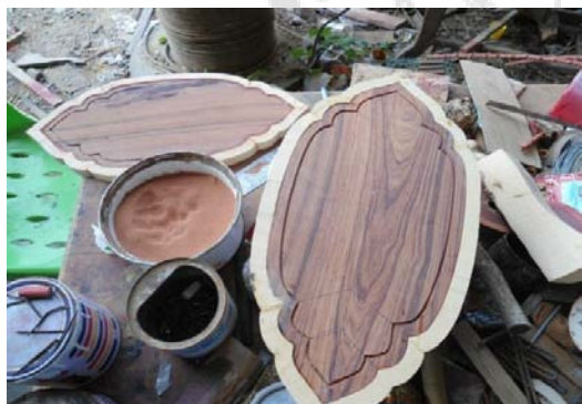
ภาพประกอบ 70 โขนระนาบเอกเซาะร่องสำหรับเดินเส้น
