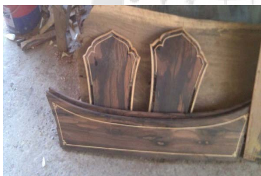
ภาพประกอบ 35 กระพุ้งและโขนพร้อมประกอบ ภาพประกอบ 36 กระพุ้งและโขนประกอบเข้าหากัน
