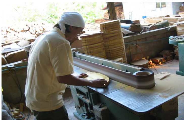
ภาพประกอบ 13 ขัดไข่นะนาดโดยเครื่องขัดกระดาษทราย
