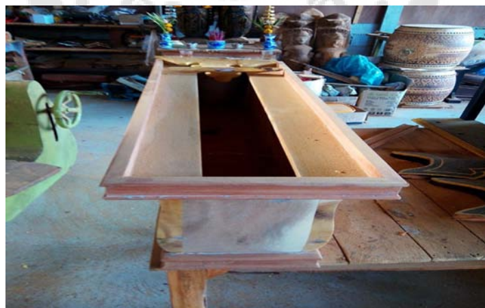
ภาพประกอบ 51 ประกอบปีกและคิ้วรางขนาดทুমเหล็ก
