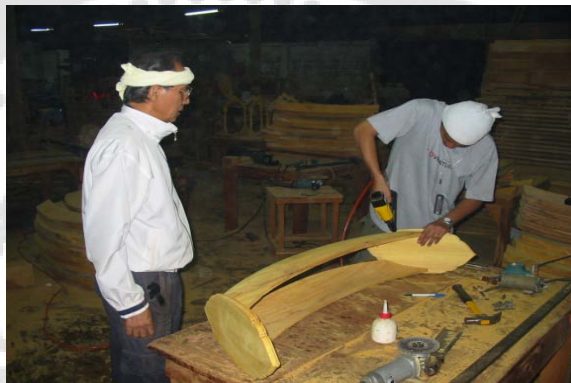
ภาพประกอบ 20 ประกอบไขนกับกระพุงเข้าด้วยกััน
