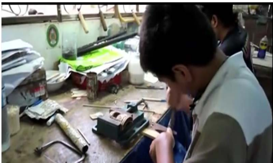
ภาพประกอบ 72 ฉลุไม้พูดเป็นเส้น
