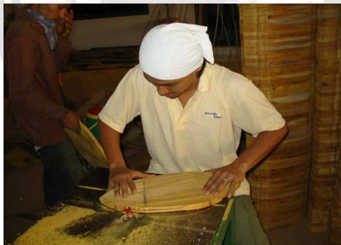
ภาพประกอบ 14 วิธีทำหัวบัวโดยใช้เครื่องเจียรหัวบัว
