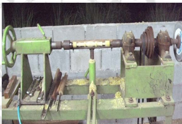
ภาพประกอบ 48 กลึงเสาขนาดทุ้มเหล็ก
