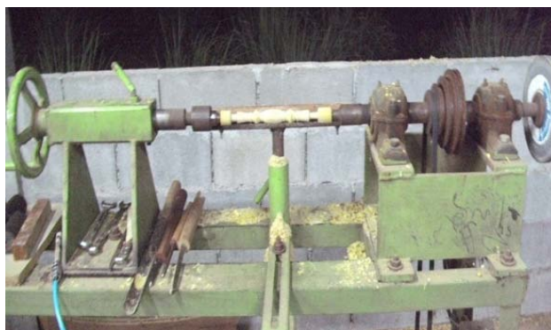
ภาพประกอบ 40 วิธีกลึงเสารางขนาดเอกเหล็ก
