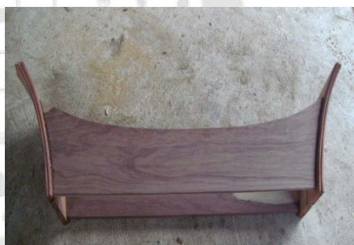
ภาพประกอบ 35 กระพุ้งและโขนพร้อมประกอบ ภาพประกอบ 36 กระพุ้งและโขนประกอบเข้าหากัน
