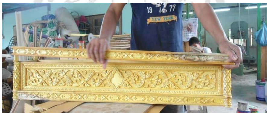
ภาพประกอบ 66 ประกอบคิ้วรางระนาดทุ้มเหล็ก
