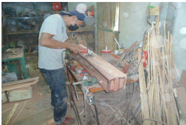
ภาพประกอบ 42 ขัดวางระนาดเอกเหล็กโดยใช้เครื่องขัด
