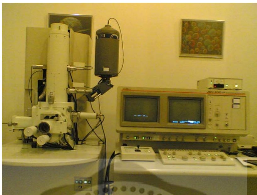
ภาพประกอบ 16 กล้องจุลทรรศน์อิเล็กตรอนแบบส่องกราด (SEM) รุ่น JSM 6301F ประเทศญี่ปุ่น
