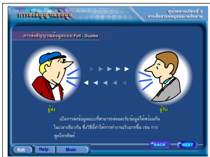
ภาพประกอบ 25 แสดงตัวอย่างการส่งสัญญาณข้อมูลแบบ Full-Duplex
