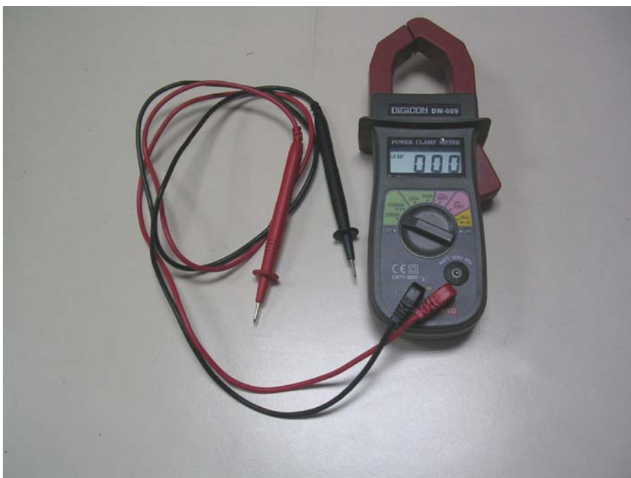
ภาพประกอบ 55 เครื่องวัดเพาเวอร์แคลมป์มิเตอร์ ยี่ห้อ Digicon รุ่น DW-609
