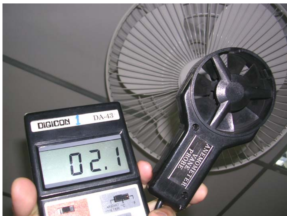
ภาพประกอบ 62 การวัดความเร็วลมหน้าตะแกรงพัดลมโคจร
