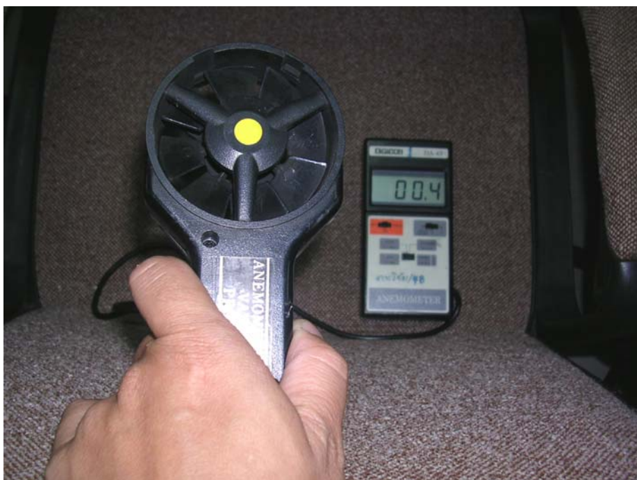
ภาพประกอบ 63 การวัดความเร็วลม ตามจุดที่นั่งภายในห้องที่ทำการทดลอง
