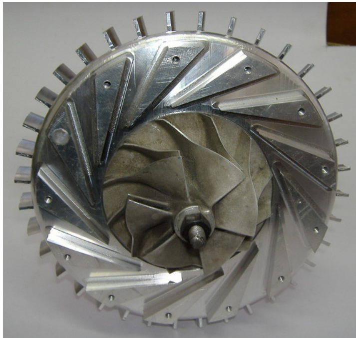
ภาพประกอบ 45 ใบพัดของเครื่องอัดอากาศ และดิฟฟิวเซอร์
