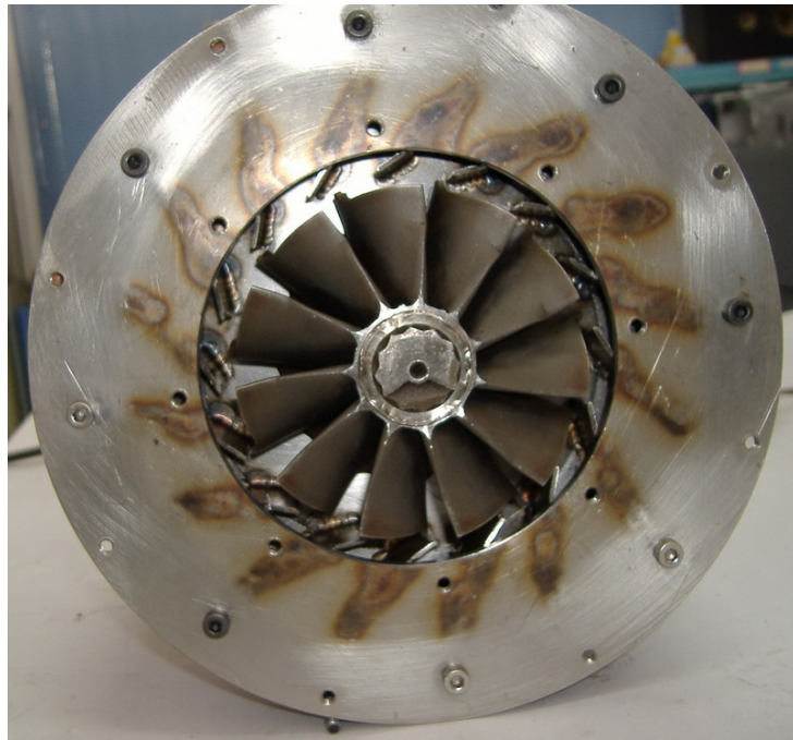
ภาพประกอบ 47 Nozzle guide vane และกังหันเมื่อประกอบเข้าด้วยกัน
