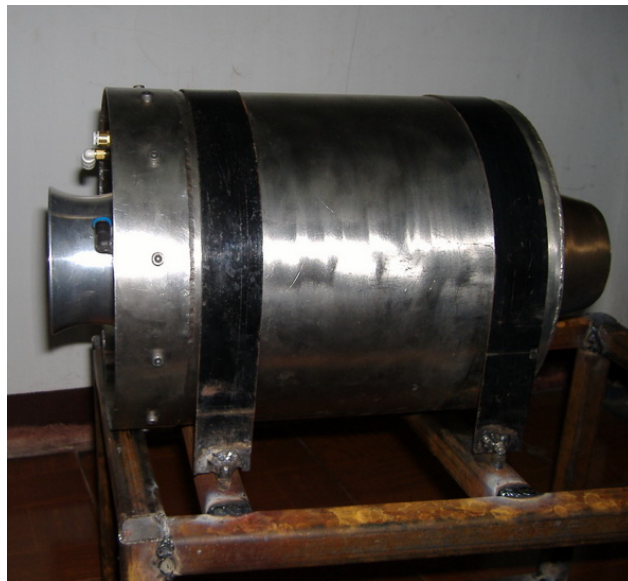
ภาพประกอบ 49 การติดตั้งเครื่องยนต์กังหันก๊าซเข้ากับแท่นเพื่อเตรียมการทดสอบ
