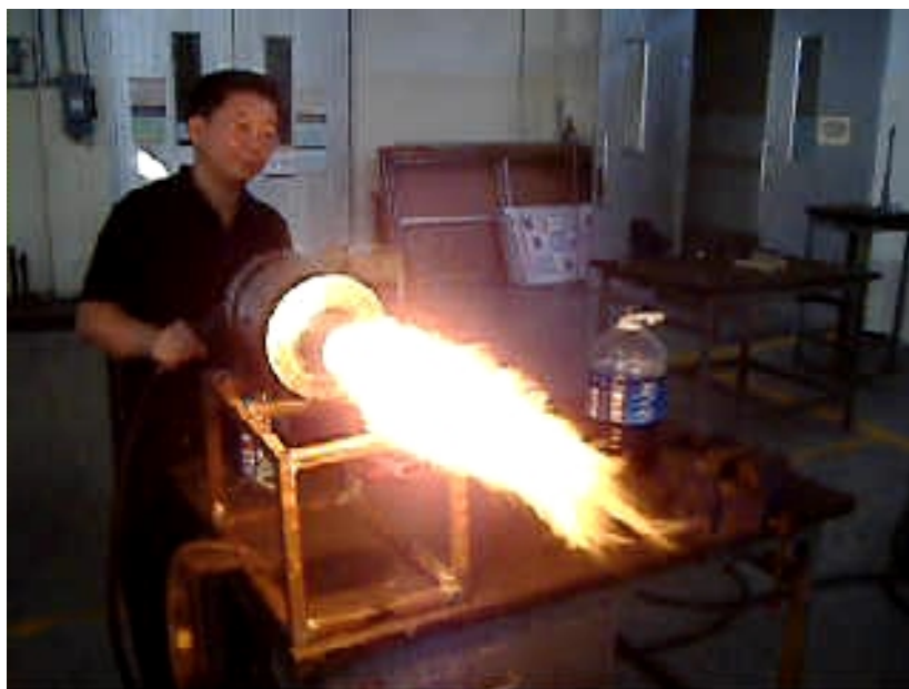
ภาพประกอบ 54 เริ่มเปิดน้ำมันเข้าไปเปลวไฟฟุ้งออกที่ท่อท้ายเครื่องยนต์กังหันก๊าซ
