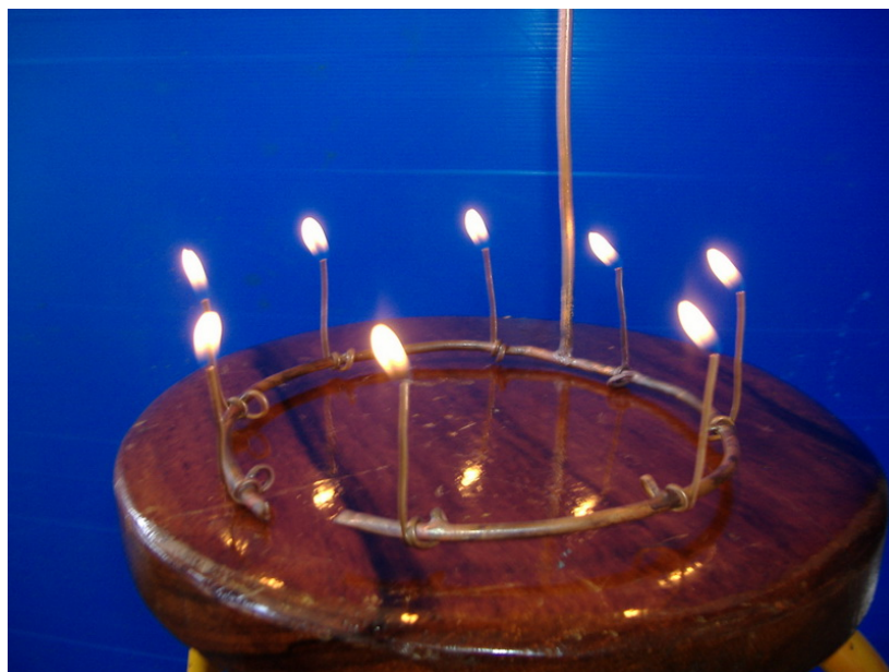
ภาพประกอบ 42 การทดสอบท่อน้ำมันเชื้อเพลิงด้วยก๊าซ LPG
