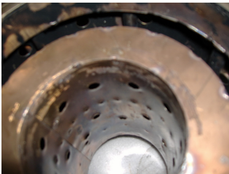
ภาพประกอบ 63 บริเวณด้านหลังของห้องเผาไหม้ส่วนในที่อากาศรั่วออกมาได้
