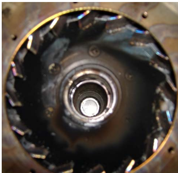
ภาพประกอบ 62 สภาพภายใน Nozzle guide vane
