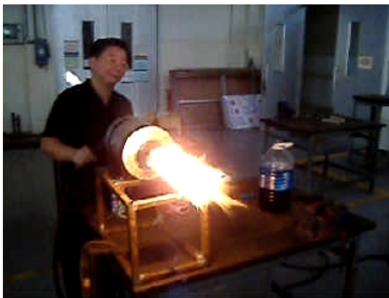
ภาพประกอบ 55 เมื่อเครื่องยัดกังหันก๊าซเพิ่มความเร็วรอบมากขึ้นอากาศเข้ามากขึ้นเปลวไฟเริ่มหดสั้นลงและมีสีอ่อนลงตามลำดับ
