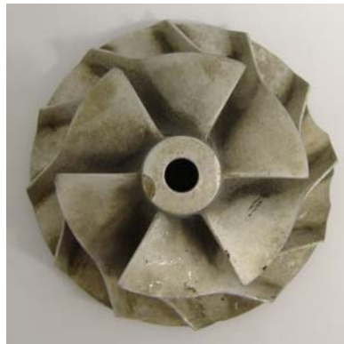
ภาพประกอบ 33 ใบพัดของเครื่องอัดอากาศที่ใช้ในการออกแบบ
