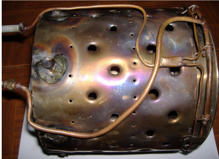
ภาพประกอบ 58 ห้องเผาไหม้ หลังจากถอดแยกออกมาจากตัวเครื่องยนต์
