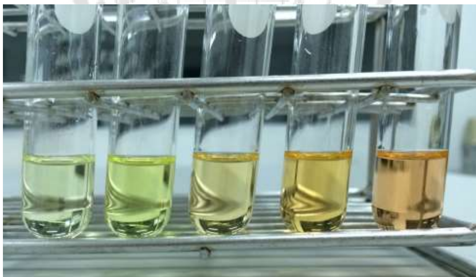
ภาพประกอบ 29 สีของสารละลายอนุพันธ์ระหว่างมาลอนไดอัลดีไฮด์กับกรดไทโอบาร์บิทูริก
