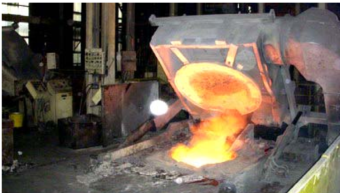
ภาพประกอบ 8 แสดงเตาหลอมไฟฟ้าแบบเหนี่ยวนำ (Induction Furnaces) ในการหลอมโลหะ
