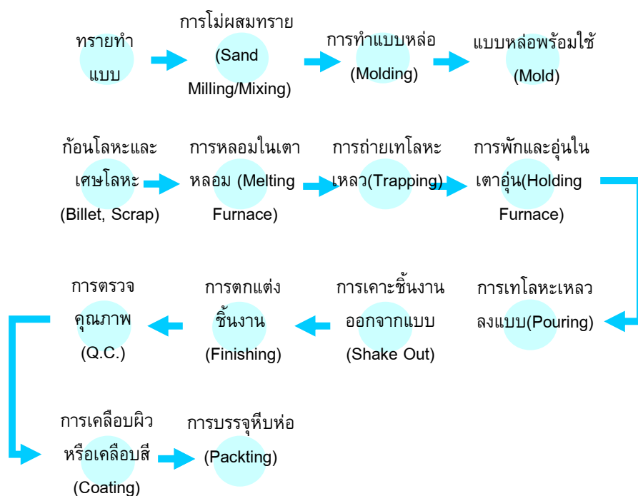
ภาพประกอบ 7 แสดงกระบวนการไหลของการหล่อโลหะ
