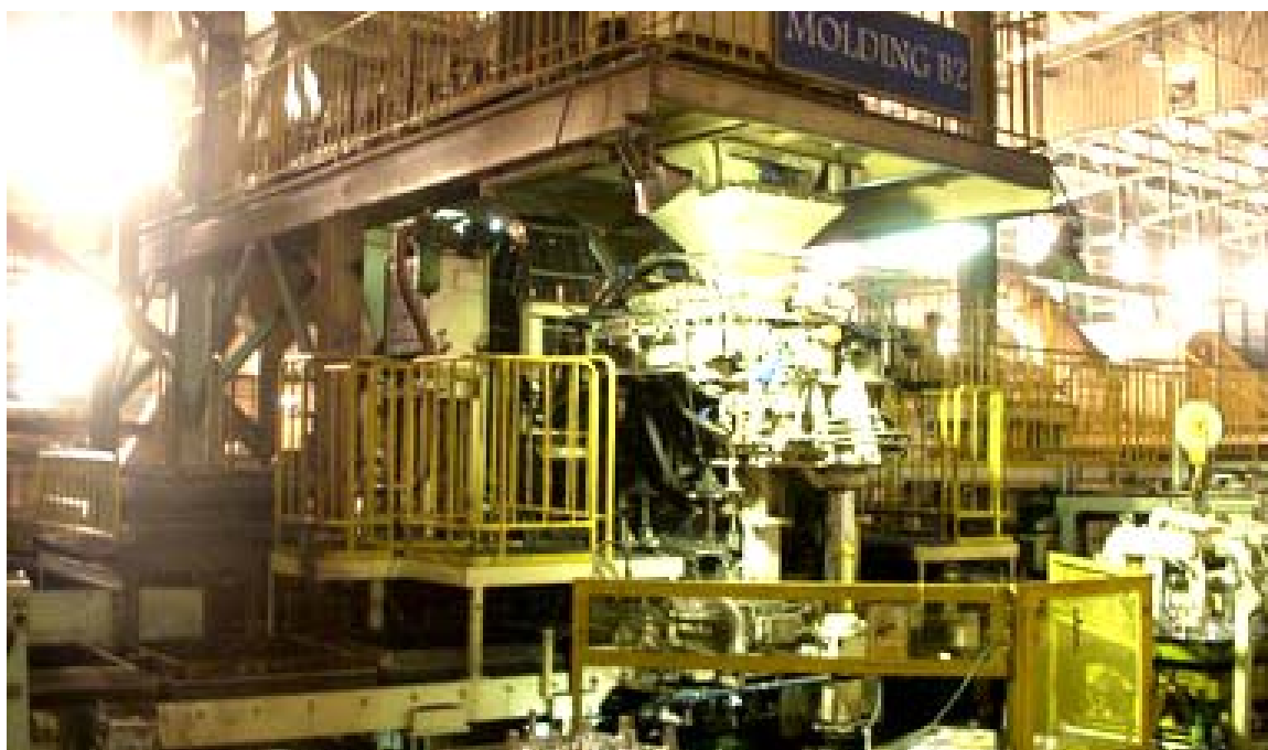
ภาพประกอบ 9 แสดงเครื่องจักรที่ใช้ในการทำแบบหล่อ (Molding)
