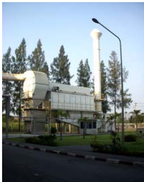
ภาพประกอบ 10 แสดงเครื่องดูดอากาศที่ใช้กับเครื่องทำแบบหล่อ(ซ้าย) และเตาหลอมเหล็ก(ขวา)
