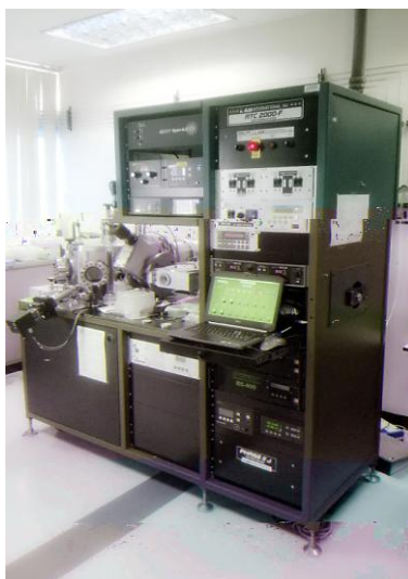
ภาพประกอบ 22 เครื่องสเป็คเตอรืกรุ่น AJA INTERNATIONAL, ATC 2000 – F
