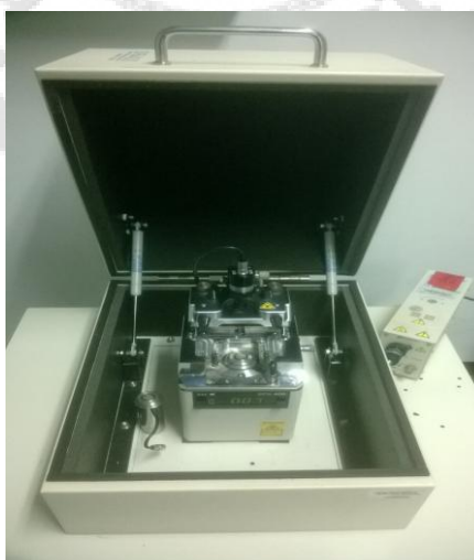
ภาพประกอบ 25 กล้องจุลทรรศน์แบบแรงอะตอมรุ่น SPA 400
