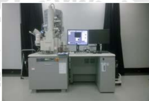
ภาพประกอบ 28 กล้องจุลทรรศน์อิเล็กตรอนแบบส่องกราด (SEM) ยี่ห้อ Hitachi รุ่น 4700
