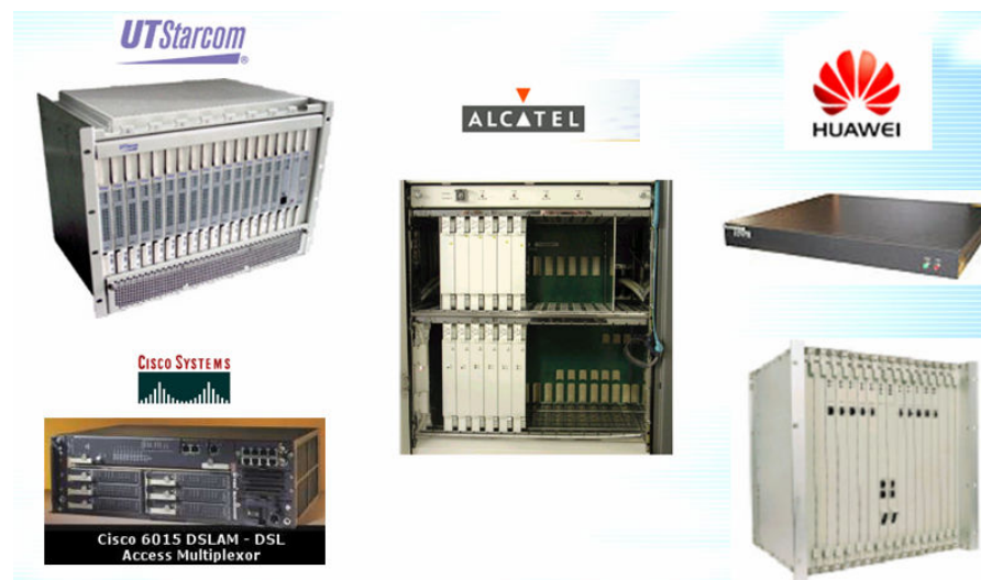
ภาพประกอบ 13 แสดงอุปกรณ์ที่ชุมสาย ซึ่งเรียกว่า ดีสแลม (Dslam)
