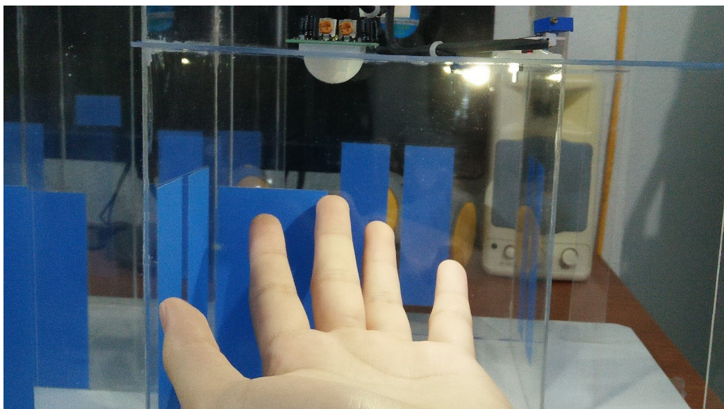
รูปภาพประกอบที่ 24 การทดลองยื่นมือเข้าไปบริเวณที่จัดรถเพื่อทดสอบ PIR Sensor
