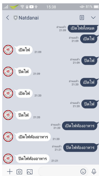
รูปภาพประกอบที่ 23 การสั่งการเปิดไฟปิดที่บ้านจำลอง Smart Home ผ่าน LINE Chatbot
