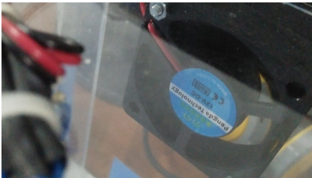
รูปภาพประกอบที่ 26 พัฒนภายในห้องรับแขกทำงานเพื่อลดอุณหภูมิภายในห้อง
