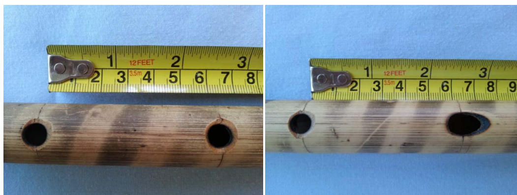
ภาพประกอบ 20 ระยะห่างจากรูที่ 3 ถึงรูที่ 4 และจากรูที่ 6 ถึงรูปล่อยลมซึ่งเป็นรูปวงรี
