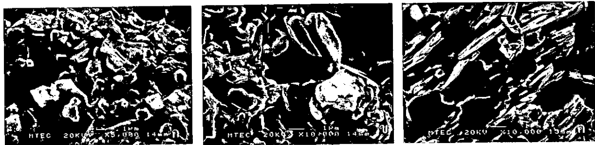
ภาพ 4.6 ภาพถ่ายจาก SEM แสดงรูปผลึกของตัวอย่างแร่ดิกไคต์ ก) DD, ข) DE และ ค) DF ตามลำดับ ภายใต้อัตราขยาย SEM
