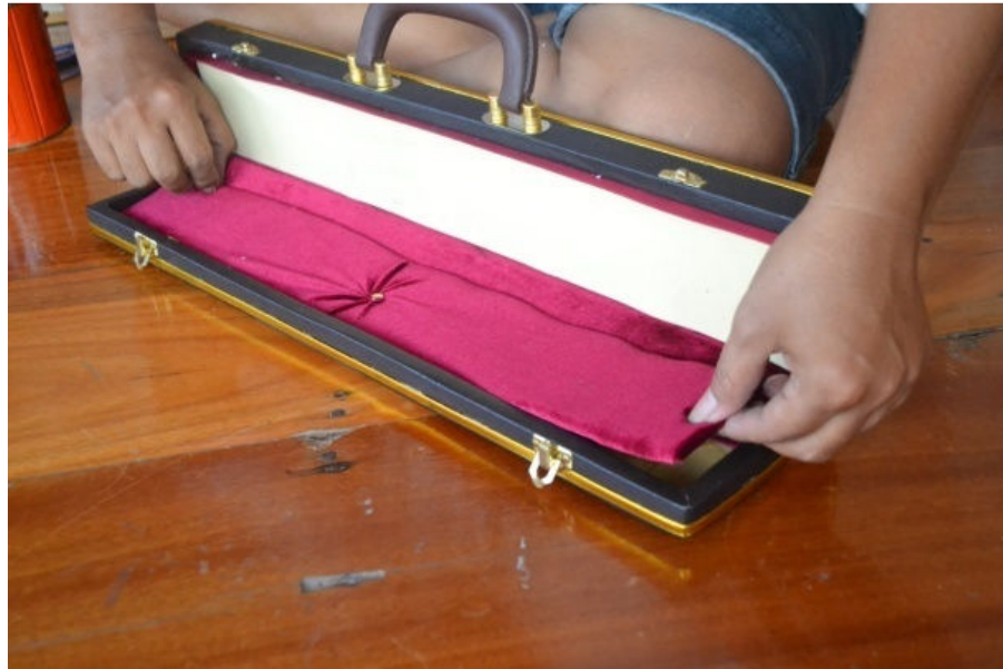
ภาพประกอบ 86 โฟมยางที่หุ้มเรียบร้อยแล้วติดลงไปที่ฝากล่อง
