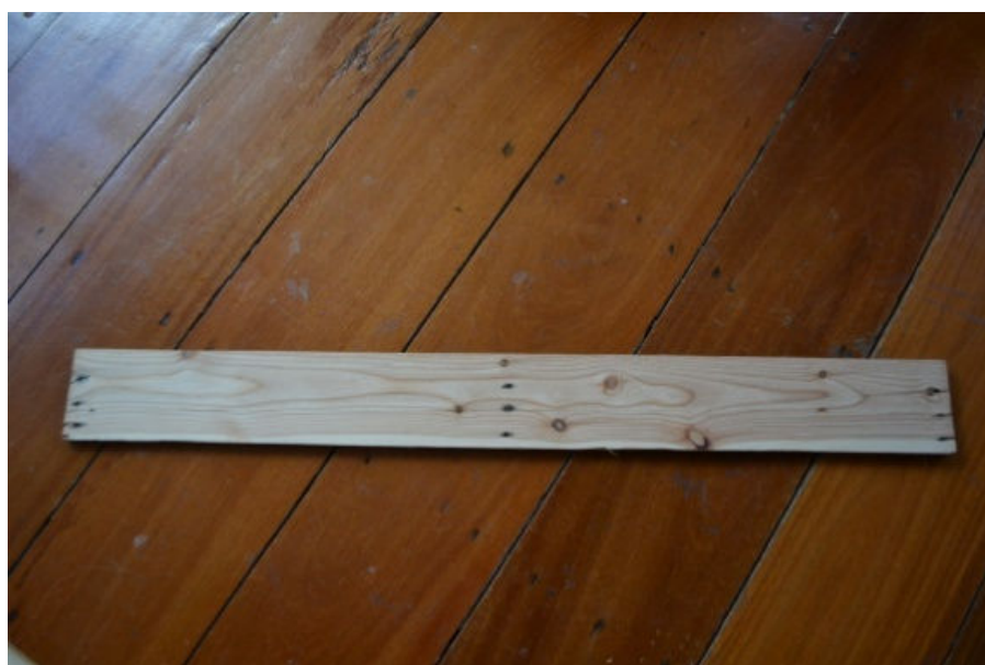
ภาพประกอบ 44 ไม้ที่ออกมาจากเครื่องรีดไม้
