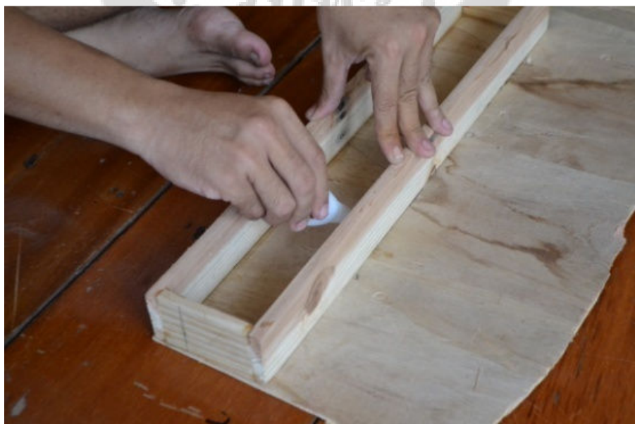
ภาพประกอบ 58 หยอดกาวร้อนเพื่อเชื่อมไม้อัดกับโครงกล่อง
