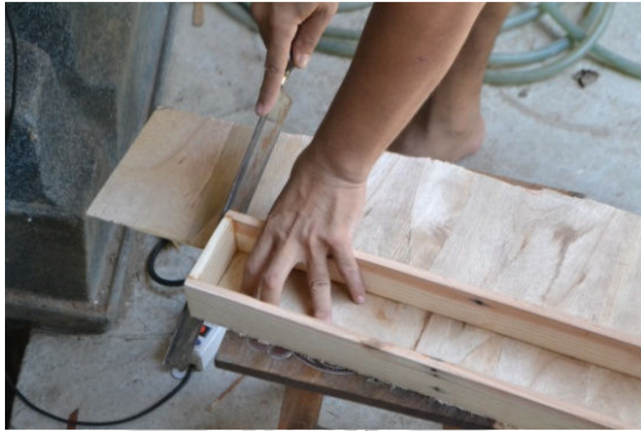
ภาพประกอบ 59 ตัดไม้อัดในส่วนที่เกินออกให้พอดีกับกล่อง
