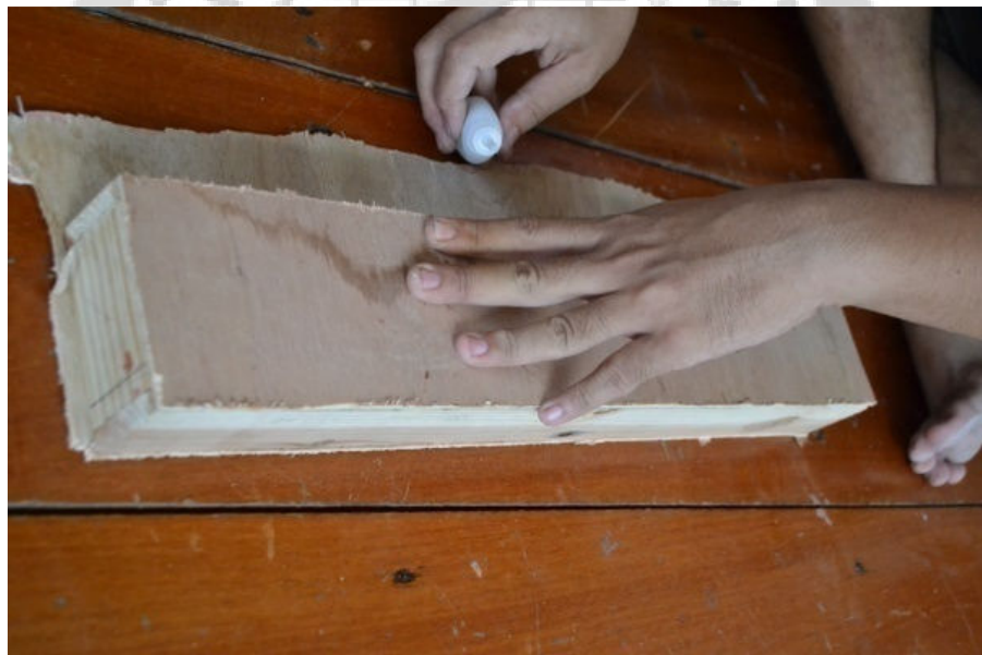
ภาพประกอบ 60 ติดไม้อัดกับโครงกล่องอีกด้าน
