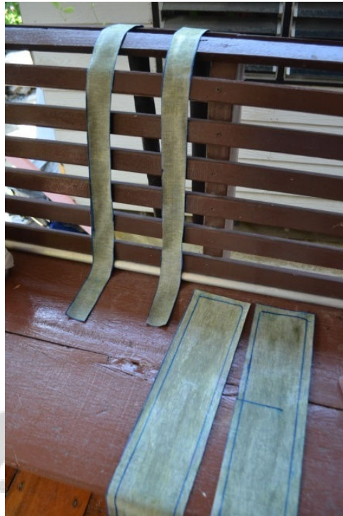
ภาพประกอบ 71 หนังสืงเทียมพีวีซี หลังจากทากาว ผึ่งให้หมาดๆ
