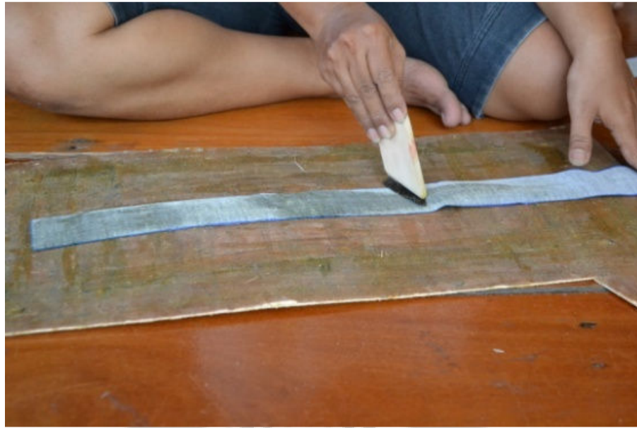
ภาพประกอบ 69 การทากาวยางที่หนังเทียมพีวีซี
