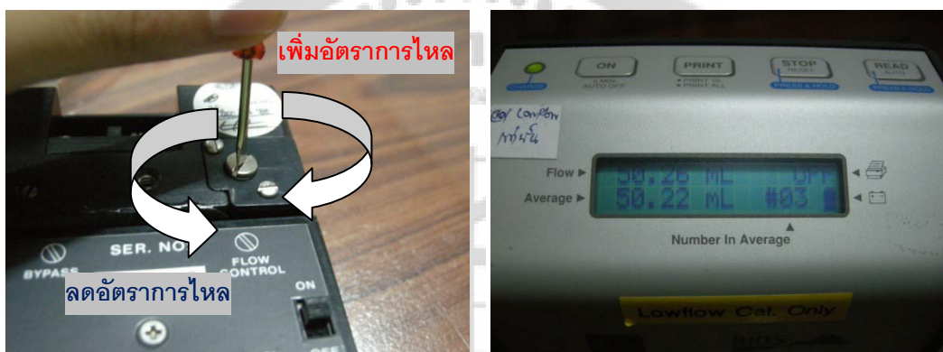
ภาพประกอบ 6 การปรับอัตราการไหลของปั๊มเก็บอากาศ
