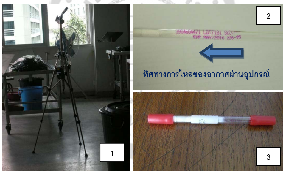
ภาพประกอบ 7 ;1 การติดตั้งอุปกรณ์เก็บฟอร์มัลดีไฮด์ในอากาศ,2 XAD2-Solid Sorbent tube,3 การเก็บ XAD2-Solid Sorbent tube ก่อนการวิเคราะห์
