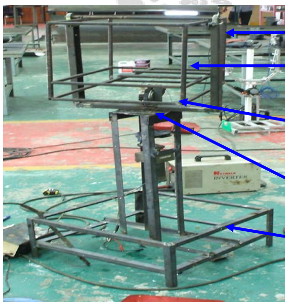
ภาพประกอบที่ 3.15 สร้างชุดโครงสร้างหลักเครื่องยิงลูกเทนนิส
