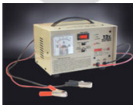
ภาพประกอบที่ 2.9 : เครื่องชาร์ตแบตเตอรี่อัตโนมัติภายนอก ( http://tsys-sports.com/product_t.php )
