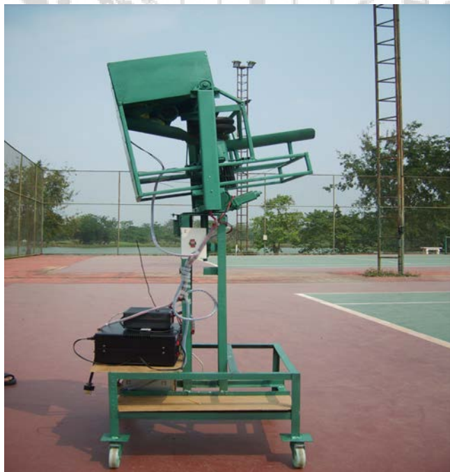
ภาพประกอบที่ 3.21 โครงสร้างภายในของเครื่องยิงลูกเทนนิสที่สร้างเสร็จแล้ว
