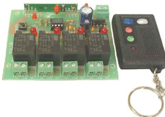
ภาพประกอบที่ 3.14 อุปกรณ์รับส่งสัญญาณบังคับระยะไกลชนิดไร้สาย
