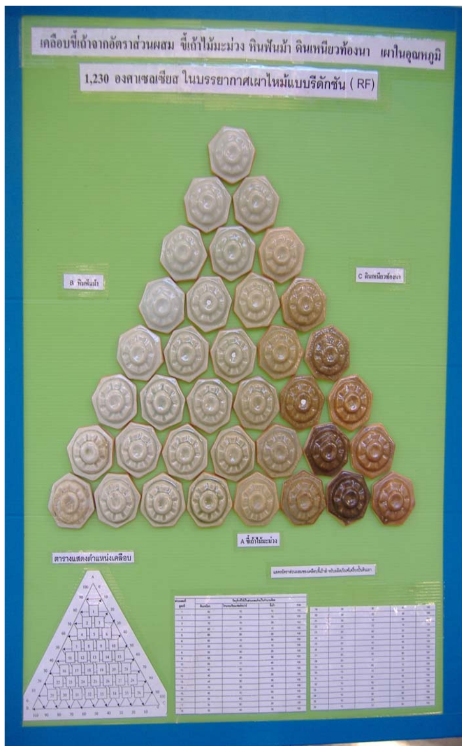
ภาพประกอบ 9 ผลการทดลองเคลือบซีเมนต์จำนวน 36 สูตร ในบรรยากาศแบบรีดักชัน
