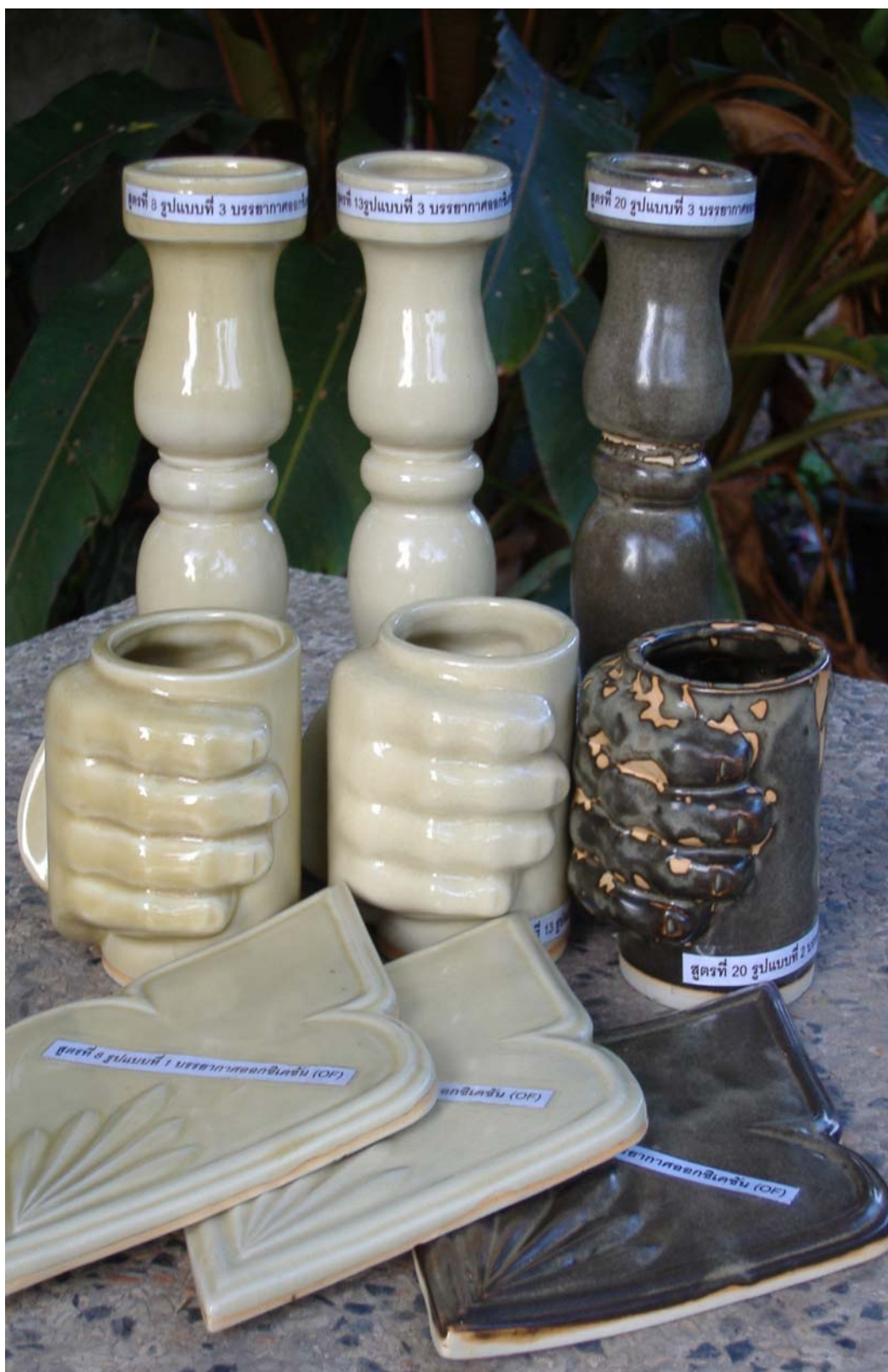
ภาพประกอบ 10 ผลิตภัณฑ์ชนิดสโตนแวร์ที่ผ่านการเคลือบขี้เถ้า เเผาในบรรยากาศแบบออกดักซัน
