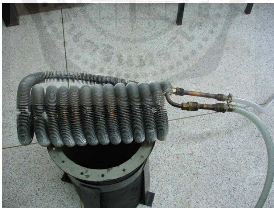
ภาพประกอบ 15 แสดงอุปกรณ์ระบายความร้อนออกจากสารทำงาน
