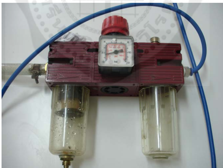
ภาพประกอบ 17 แสดงอุปกรณ์ปรับความดันและดักน้ำออกจากสารทำงาน
