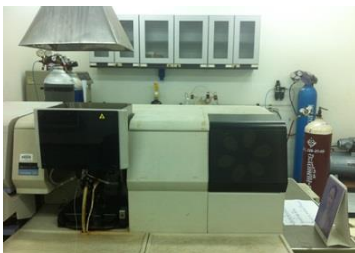
ภาพประกอบ 22 อะตอมมิกแอบซอร์ปชันสเปกโตรโฟโตมิเตอร์ยี่ห้อ Perkin Elmer รุ่น AAnalyst 300
