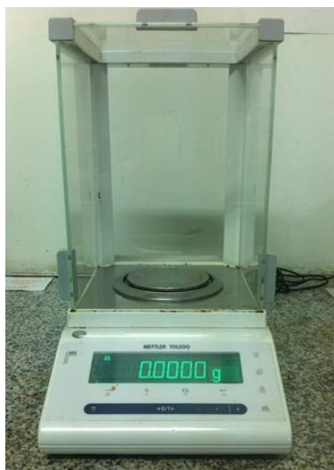
ภาพประกอบ 20 เครื่องชั่งอย่างละเอียด 4 ตำแหน่ง
