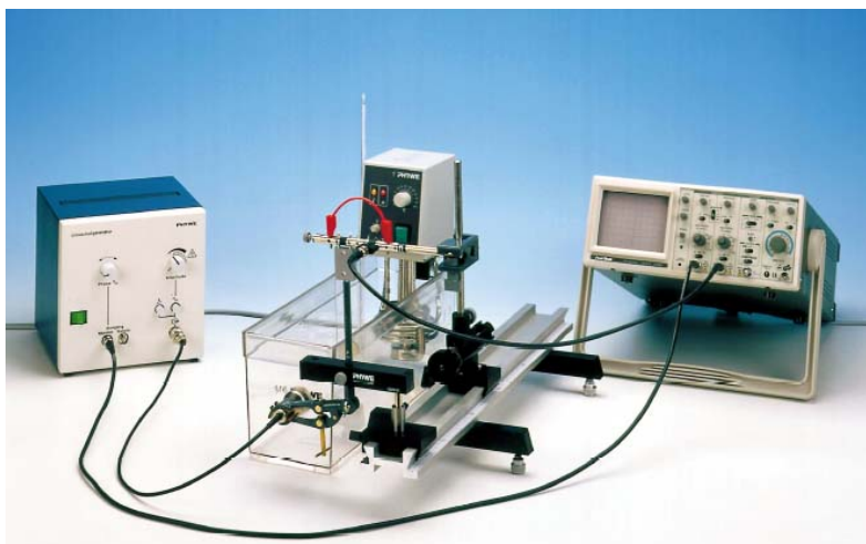
ภาพประกอบ 14 การติดตั้งอุปกรณ์ที่ใช้ในการวิจัย (การหาความเร็วคลื่นอัลตราโซนิก)
