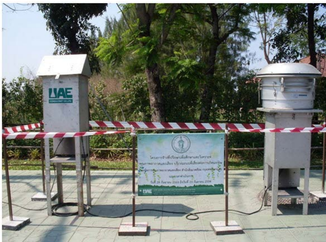
ภาพประกอบ ผ2 เครื่องเก็บตัวอย่างฝุ่นละอองแบบ High Volume Air Sampler
