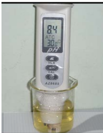
รูปที่ 4.18 วัดค่า pH ของน้ำมันไบโอดีเซล ด้วย pH meter pen type รุ่น 8685
