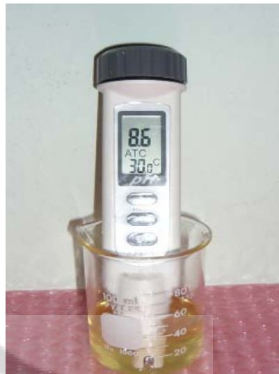
รูปที่ 4.18 วัดค่า pH ของน้ำมันไบโอดีเซล ด้วย pH meter pen type รุ่น 8685
