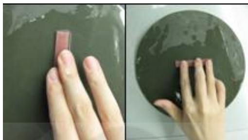
ภาพประกอบ 4 แสดงการขัดชิ้นงานอะคริลิกเรซินสำหรับทดสอบคุณสมบัติทางกล
