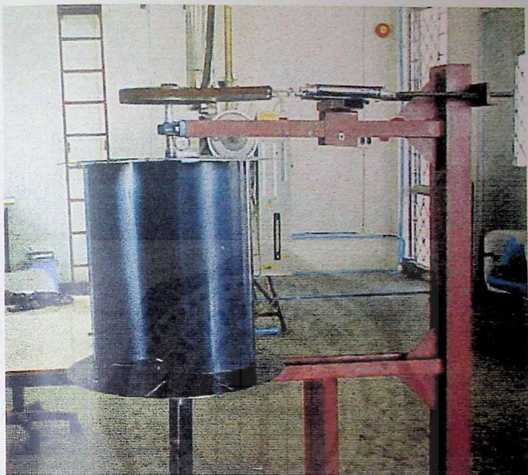
รูปภาคผนวกที่ 2.3 แสดงกังหันพร้อมกับแท่น และไดนาโมมิเตอร์
