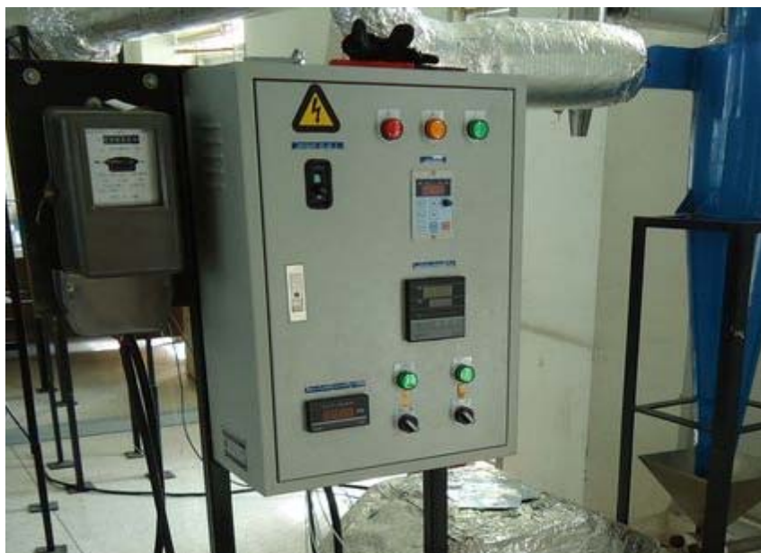
ภาพประกอบ 36 ชุดควบคุมอุณหภูมิและความเร็วรอบของเครื่องเป่าลม พร้อมมาตรวัดหน่วยพลังงาน
