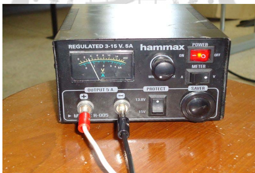
ภาพประกอบ 28 ตัวคุมแรงดันไฟฟ้าของเครื่องป้อนวัสดุ
