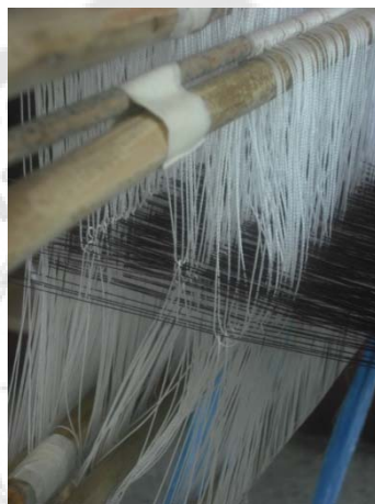
ภาพประกอบ 5 ตะกอ (Harness with heddle OR Heddle)
