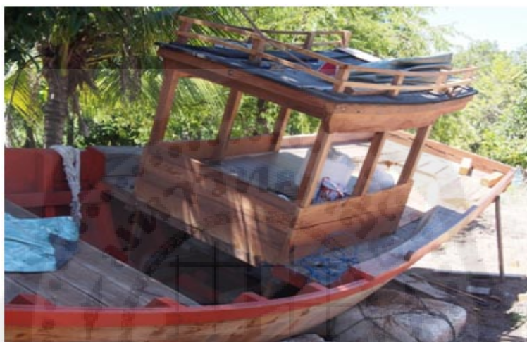
ภาพประกอบ 83 เก่งหรือดาตไฟฟ้าเรือที่ติดตั้งเสร็จแล้วของอู่ต่อเรือจังหวัดจันทบุรี
