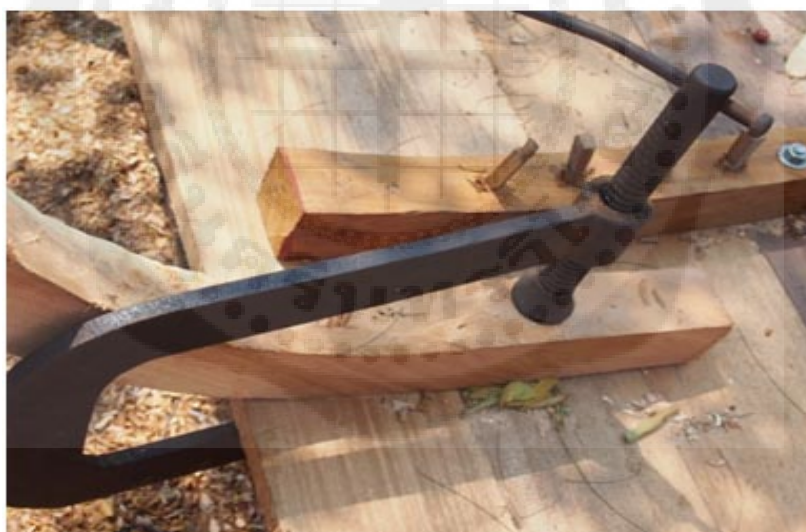
ภาพประกอบ 62 การนำปากกาจับระหว่างกงข้างกับไม้กระดานแผ่นที่ 2 ของอุ้งต่อเรือจังหวัดชลบุรี
