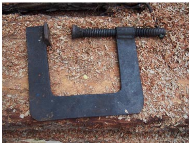
ภาพประกอบ 73 อุปกรณ์หนีบจับไม้กระดานของอุต่อเรือจังหวัดชลบุรีและจันทบุรี
