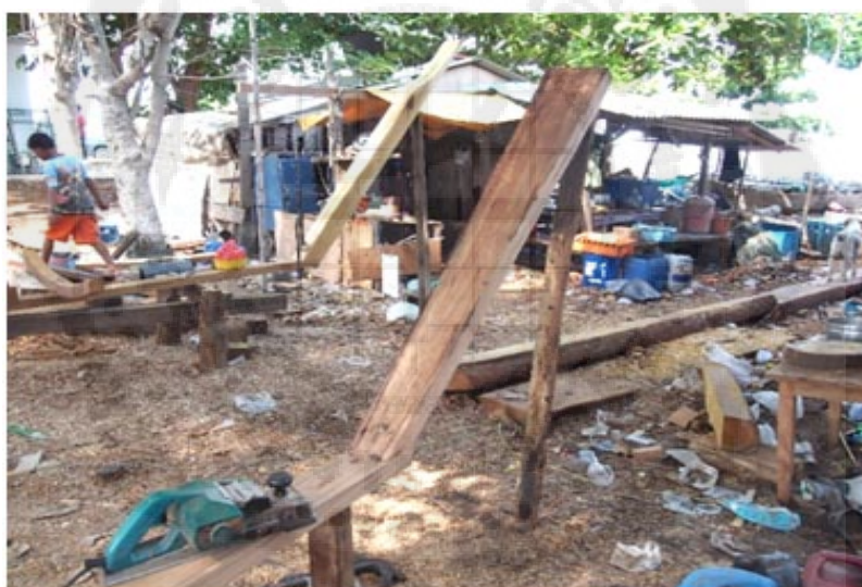
ภาพประกอบ 58 การติดตั้งหัวโขนเรือของอุ้งต่อเรือจังหวัดชลบุรี
