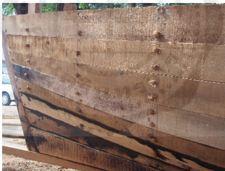
ภาพประกอบ 53 ด้านนอกเรือแสดงตำแหน่งการใส่ลูกประตักเพื่อยึดระหว่างก้งข้างกับแผ่นกระดานของอู่ต่อเรือจังหวัดชลบุรี
