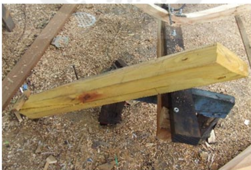
ภาพประกอบ 56 เตรียมไม้หัวโขนเรือของอุต่อเรือจังหวัดชลบุรี
