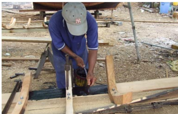
ภาพประกอบ 63 การทาน้ำมันเครื่องใช้แล้วก่อนนำไฟมาลน ของอุ้งต่อเรือจังหวัดชลบุรี
