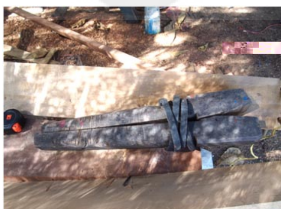
ภาพประกอบ 72 อุปกรณ์หนีบจับไม้กระดานของอุ้งต่อเรือจังหวัดระยอง
