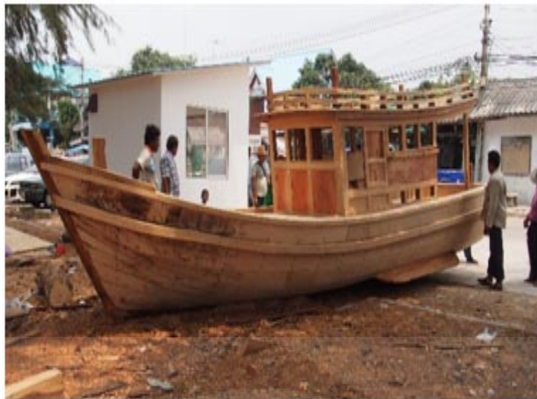
ภาพประกอบ 81 เรือที่ติดตั้งแก๊วเรือแล้วของคู่อเรือจังหวัดชลบุรี
