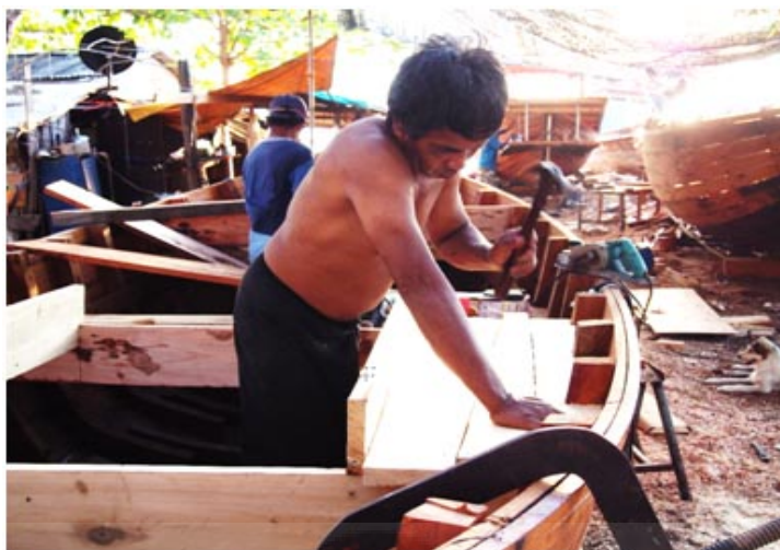
ภาพประกอบ 77 การติดตั้งพื้นเรือของคู่อู่เรือจังหวัดชลบุรี
