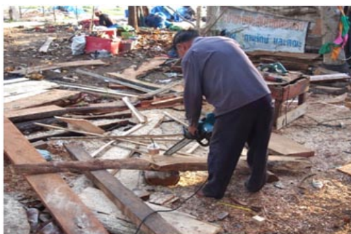
ภาพประกอบ 8 การใช้เลื่อยยนต์ตัดท่อนไม้เพื่อทำงวงเรือ
