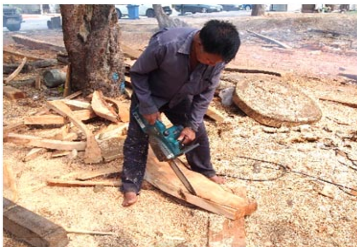
ภาพประกอบ 42 เมื่อร่างแบบเสร็จแล้ว จึงนำมาตัดตามต้นแบบกงโดยใช้เลื่อยไฟฟ้าของคู่อเรือในจังหวัดชลบุรี
