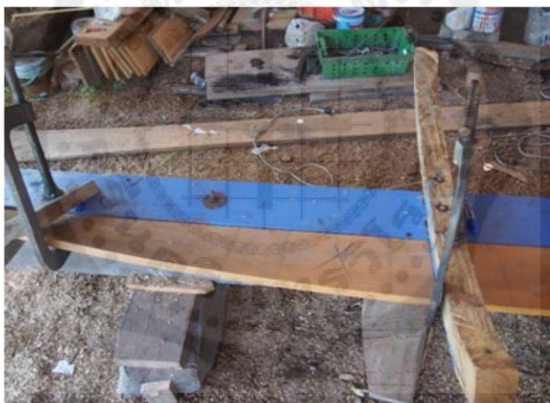
ภาพประกอบ 67 การติดตั้งไม้กระดานแผ่นที่ 1 ของคู่อเรือจังหวัดจันทบุรี
