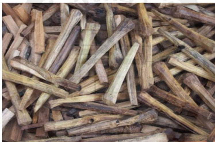
ภาพประกอบ 46 ลูกประสักที่เหลาเรียบร้อยแล้วจะมีลักษณะหัวใหญ่ด้านบนส่วนด้านล่างเรียว เล็กลงมาต้องทำมาจากไม้แสมสาร ใช้ลูกประสักแทนตะปูเพื่อความคงทนแข็งแรงเพราะไม่ เป็นสนิม เมื่อแช่อยู่ในน้ำทะเลตลอดเวลาของอู่ต่อเรือจังหวัดชลบุรี
