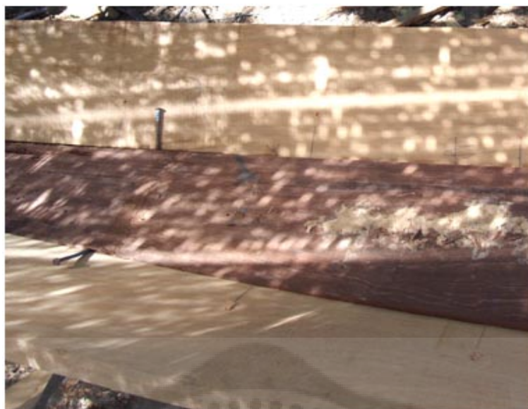
ภาพประกอบ 91 การตอกตะปูยึดไม้กระดานข้างเรือของคู่อัดเรือในจังหวัดระยอง
