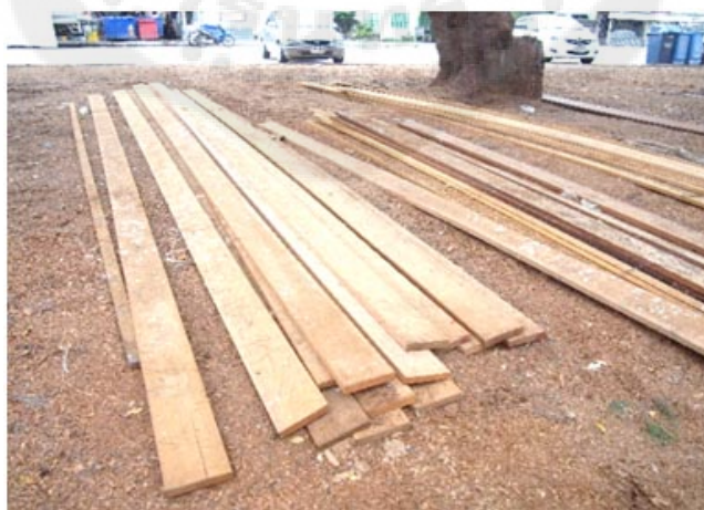
ภาพประกอบ 43 เตรียมไม้กระดานข้างเรือของคู่อเรือในจังหวัดชลบุรี
