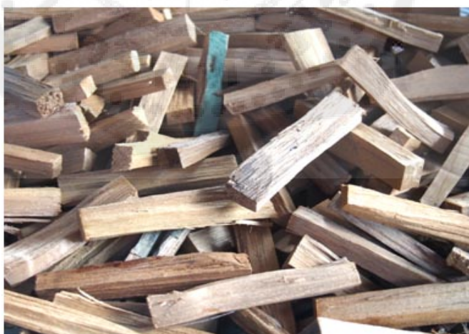
ภาพประกอบ 44 การเตรียมไม้แสมสารสำหรับทำลูกประสักของอู่ต่อเรือจังหวัดชลบุรี
