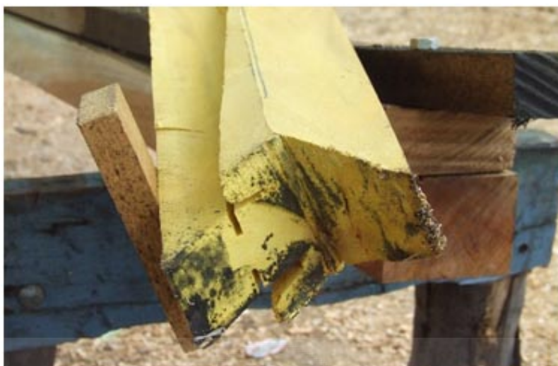
ภาพประกอบ 57 การบากไม้หัวโขนเรือเป็นรูปตัววีของอุ้งต่อเรือจังหวัดชลบุรี
