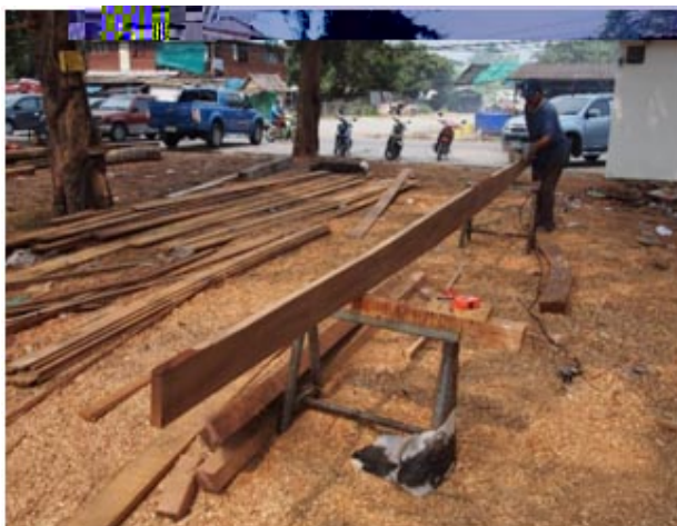
ภาพประกอบ 37 การใส่ไม้เตรียมทำกระดูกของอุต่อเรือในจังหวัดชลบุรี
