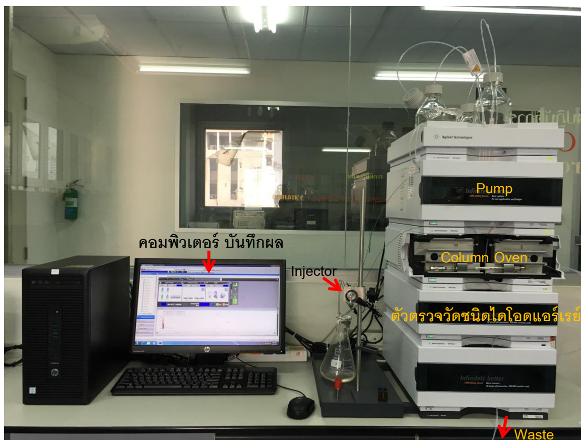
ภาพประกอบ 22 เครื่องโครมาโทกราฟีของเหลวสมรรถนะสูง (HPLC) รุ่น HPLC-1260
