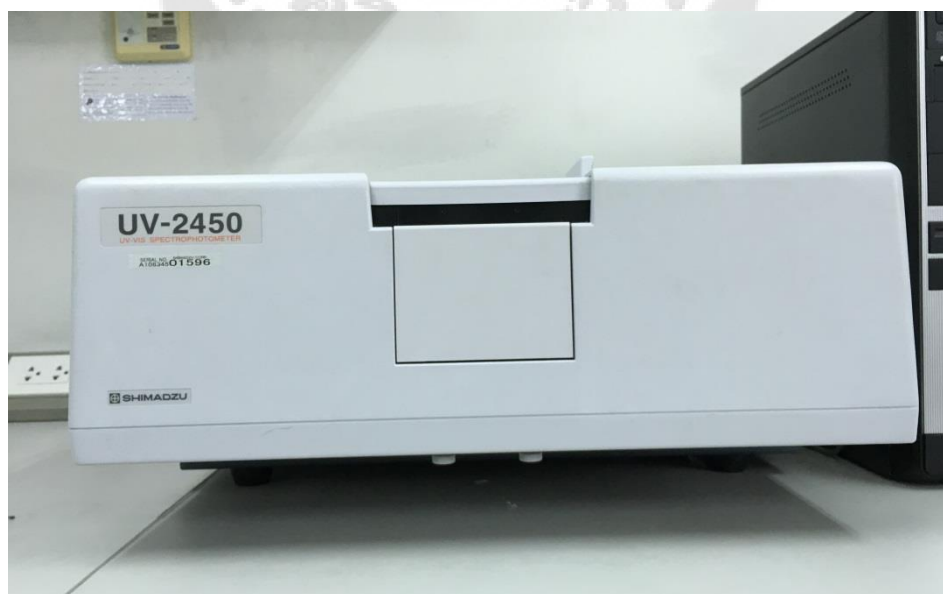
ภาพประกอบ 23 เครื่องสเปกโตรโฟโตมิเตอร์ รุ่น UV-2450
