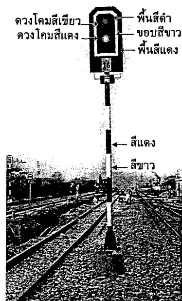
ภาพประกอบ 16 เสาสัญญาณออก Starter signal (การรถไฟแห่งประเทศไทย. 2543 : 16)
