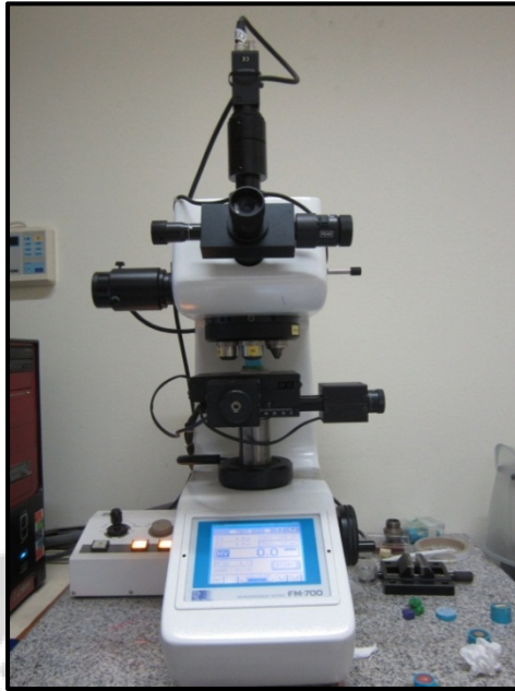
ภาพที่ 2 เครื่องวัดความแข็งผิวที่ใช้ในการทดลองนี้
