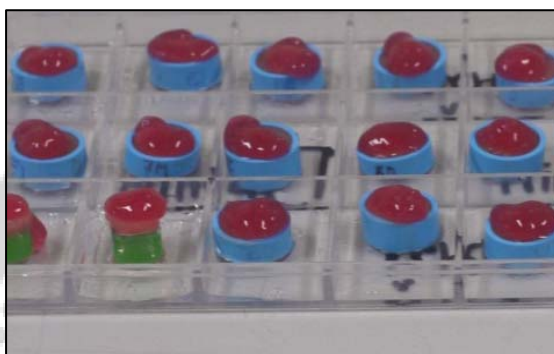
ภาพที่ 4 แสดงขั้นตอนการทาฟลูออไรด์เจลที่ผิวชิ้นงานตัวอย่าง
