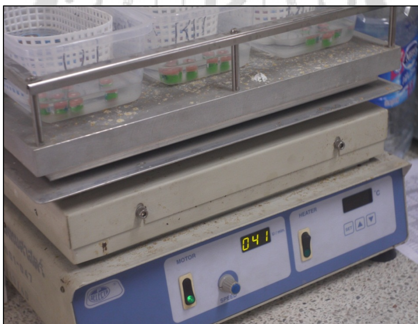
ภาพที่ 9 แสดงการแช่ชิ้นงานตัวอย่างในสารละลายสำหรับการคืนกลับของแร่ธาตุบนเครื่องคนสารเพื่อป้องกันการตกตะกอนของสารละลาย
