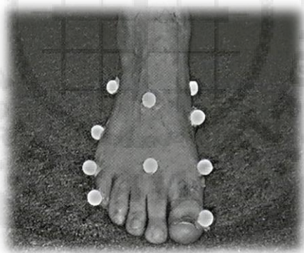
ภาพประกอบ 8 ตัวอย่างการติดมาร์คเกอร์แบบสะท้อนแสงอินฟราเรด
